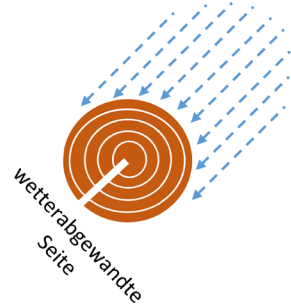
Bild 135: Zusammenhang zwischen Feuchteanreicherung und Rissen, Beschichtungen sowie Entlastungsnuten in Rundholz; Darstellung in Anlehnung an [60 S. 61]
