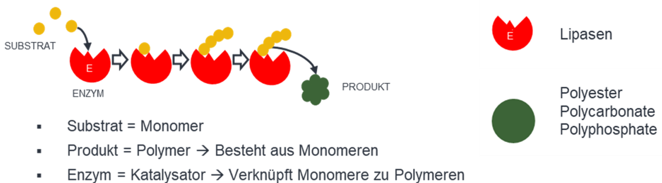
Abbildung 2-12: Schematische Darstellung des Funktionsprinzips einer enzymatischen Polymerisation.
