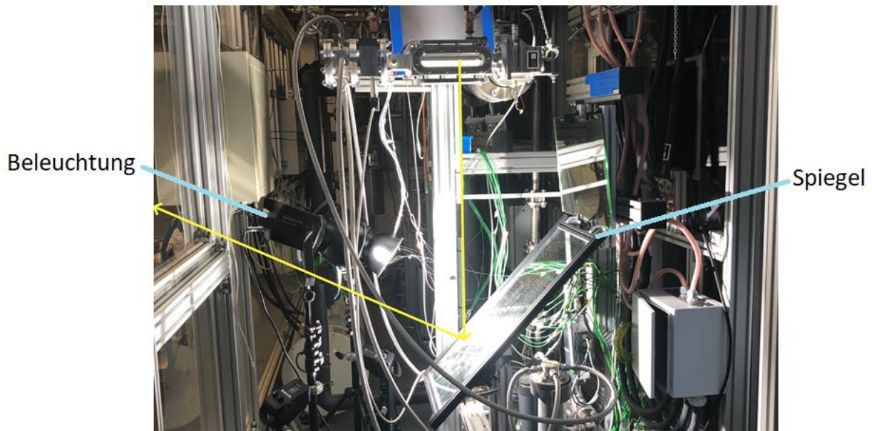
Abbildung 3-11: Seitenansicht der geeigneten Teststrecke mit dem optischen Aufbau und Strahlengang (gelber Pfeil).
