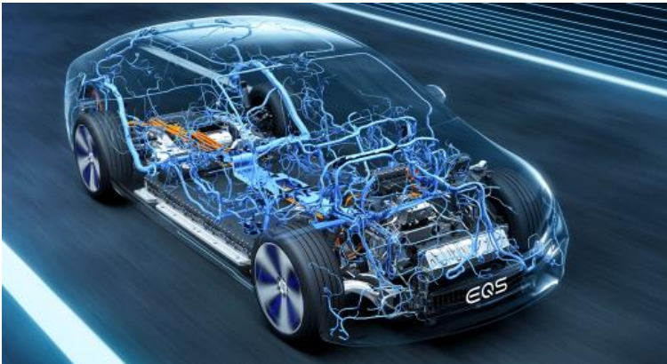
Abbildung 2.9: Darstellung des Gesamtleitungssatzes in einem batterieelektrischen Fahrzeug des Typs EQS (Heinrichs, 2021, S. 2)
