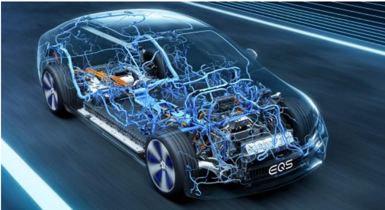
Abbildung 1.1: Der Leitungssatz, hier dargestellt in blau (Low-Volt) und orange (High-Volt) (Heinrichs, 2021, S. 2), ist ein komplexes System mit 5 km kombinierter Leitungslänge und mehr als 1200 Einzelkomponenten, bei dem aufgrund der Variantenvielfalt mehr als jeder dritte Leitungssatz eine neue Konfiguration darstellen kann (König, 2016, S. 12–13; Neckenich, 2018, S. 7).
