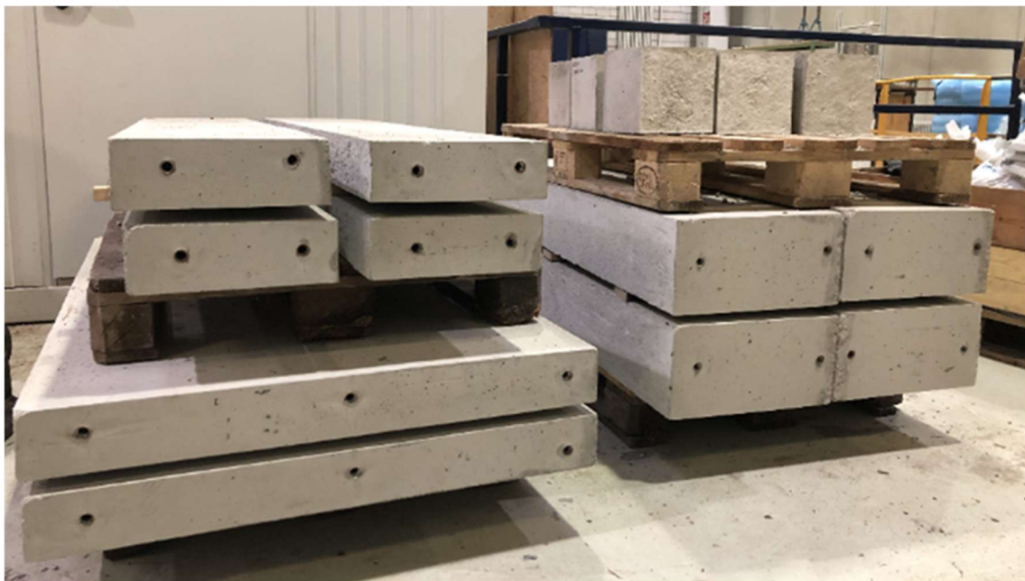
Abbildung 34: Hergestellte Betonprobekörper der Betonfestigkeitsklasse C25/30 (Rentschler et al. 2023b)
