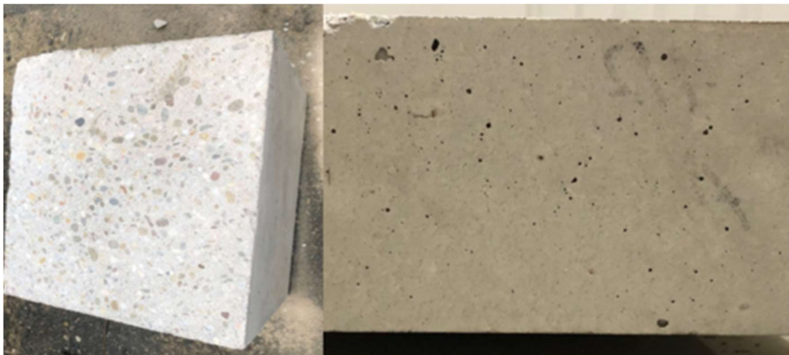
Abbildung 6: Links: Gesteinskörnung am Betonkörper, Rechts: Luftporen am Betonkörper
