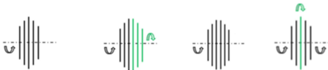
Abbildung 41: Von links nach rechts: Demonstrator 1 gleichdrehend; Demonstrator 2 gegendrehend, Demonstrator 3 gleichdrehend, Demonstrator 4 gegendrehend (eigene Darstellung nach (Kurt Heppler et al. 2021))
