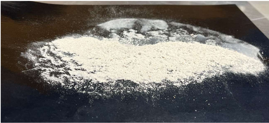
Abbildung 64: Überblick Staubprobe Versuchsreihe 69, Demonstrator 1, v = 5 \text{ mm/s} , d = 15 \text{ mm} , C30/37
