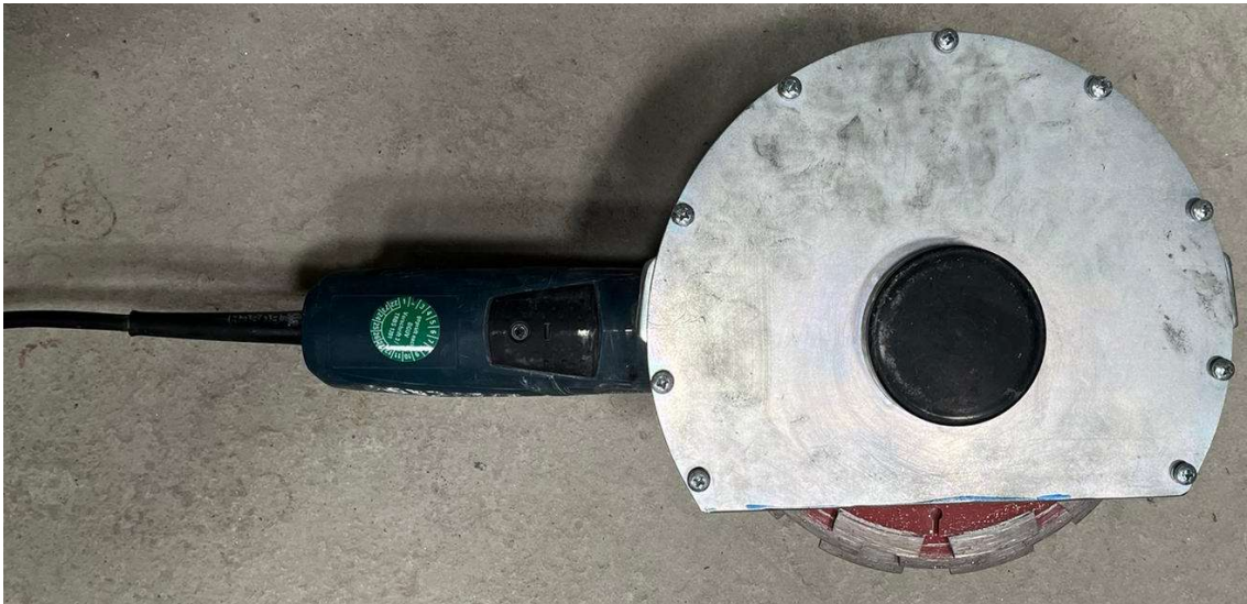
Abbildung 21: Erster Demonstrator, Antrieb mit Einhausung und fünf Diamantscheiben
