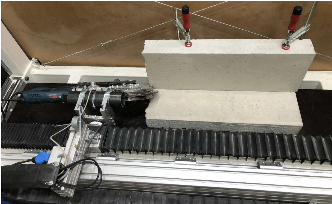
Abbildung 36: Beispiel eines vorbereiteten Versuchsablaufs mit dem zweiten Demonstrator an einer erstellten Innenkante aus Betonkörpern
