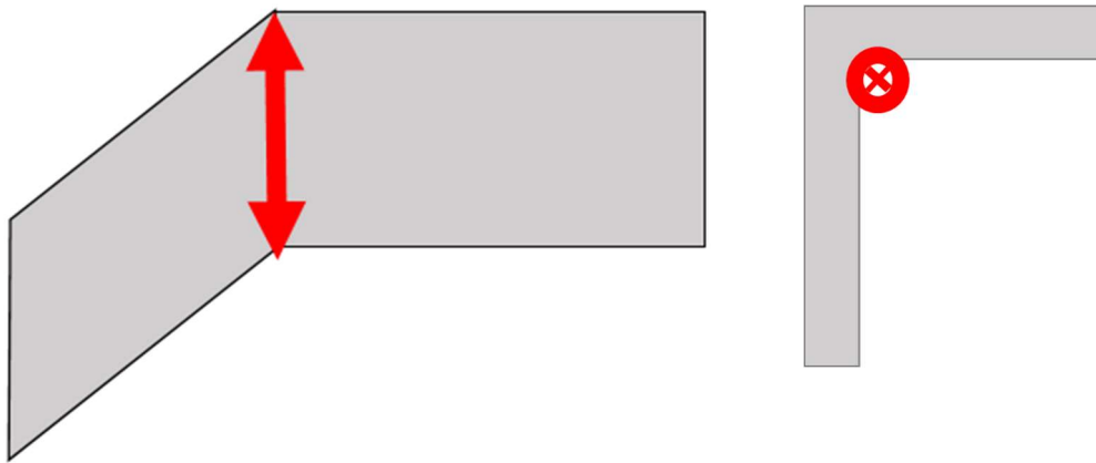
Abbildung 7: Links: Darstellung des Innenkantenbereichs (roter Doppelpfeil) an der Schnittgeraden von zwei Ebenen, Rechts: Draufsicht
