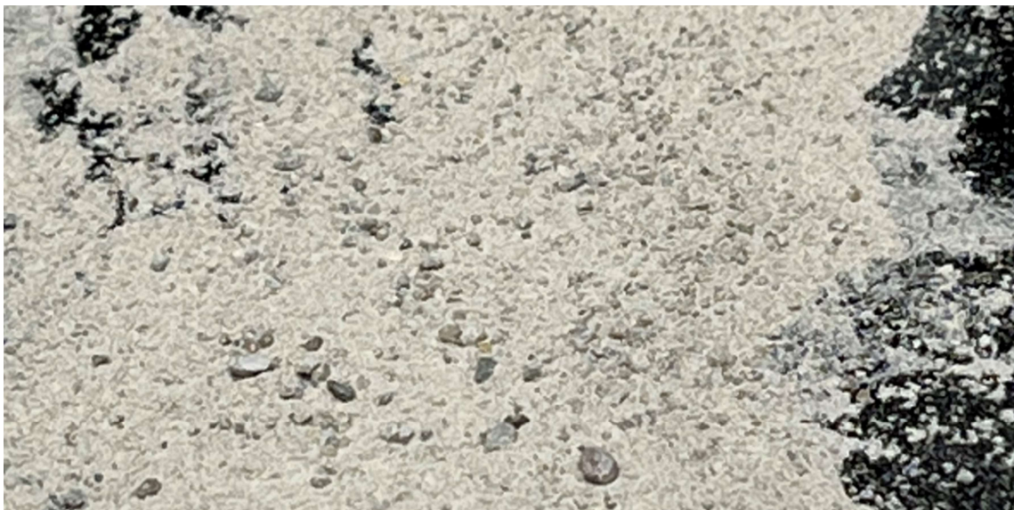
Abbildung 65: Detail Staubprobe Versuchsreihe 69, Demonstrator 1, v = 5 \text{ mm/s} , d = 15 \text{ mm} , C30/37
