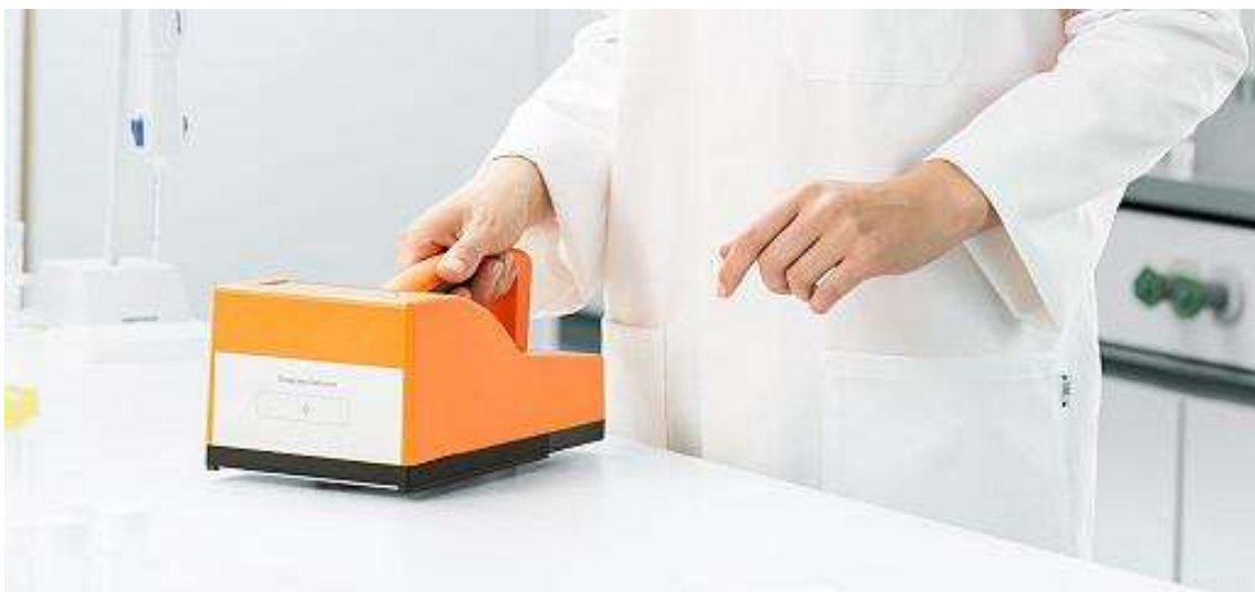
Abbildung 13: Handgeführter Kontaminationsmonitor der Firma Berthold Technologies (Berthold Technologies GmbH & Co.KG 2021)
