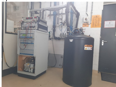
Abbildung 3-7: a) PPMS für T_{c,ind} -Messung, in dem der Probenhalter während der Messung platziert und mittels Helium gekühlt wird b) Die Probe befindet sich während der T_{c,ind} -Messung zwischen Erreger- und Empfängerspule des Probenhalters.
