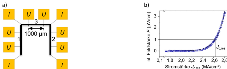
Abbildung 3-8: a) Photolithographisch strukturierte Stege für die J_{c,res} -Messung; Länge: 1000 \mu\text{m} , Breite 50 \mu\text{m} (1, 2) und 20 \mu\text{m} (3), an quadratischen, mit Gold beschichteten Kontaktflächen erfolgt die Stromeinleitung ( I ) und der Spannungsabgriff ( U ). Bei eingestellten B und T wird der Gleichstrom I durch einen Steg solange erhöht, bis der Spannungsabfall U über die Messstrecke von 1000 \mu\text{m} einer kritischen elektrischen Feldstärke von E_{krit} = 10^{-6} V/cm entspricht. b) Exemplarische Ermittlung von J_{c,res}
