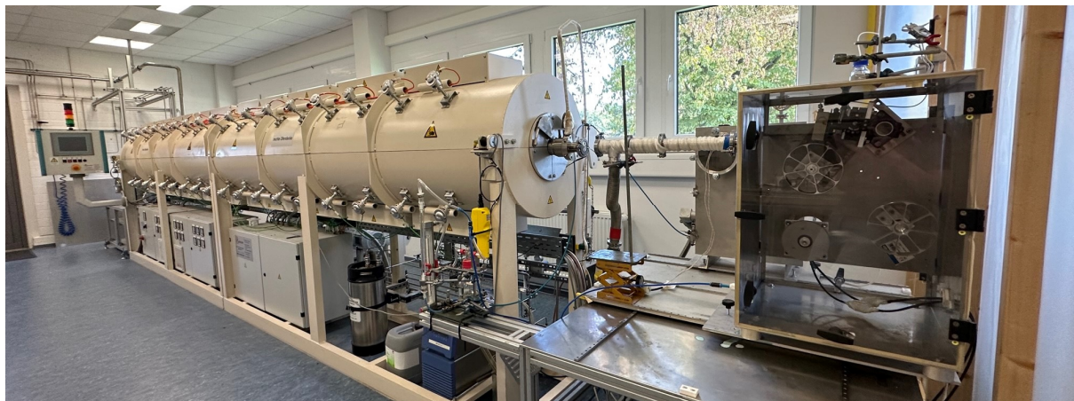
Abbildung 3-15: Verwendeter Rohrofen für Beschichtung und Pyrolyse von Bandproben im Rolle-zu-Rolle-Verfahren. Die mit feuchtem Stickstoff durchspülte Beschichtungskammer ist rechts angeschlossen. Dazwischen befindet sich das auf 70 °C erhitze Rohrstück (weiß isoliert), in dem der Großteil des Methanols verdampft und zusammen mit dem feuchten Spülgas aus der Beschichtungskammer abgesaugt wird. Danach fährt der fast trockene Film in den Rohrofen.
