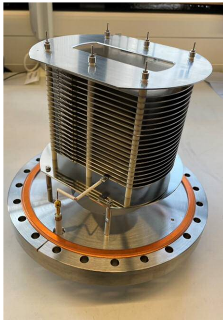
Abbildung 20: Fotografie des zweistufigen Reflektors. Es handelt sich um ein adaptiertes, kommerzielles Instrument von Jordan TOF Products.
