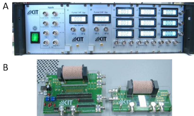
Abbildung 31: A: Fotografie der Spannungsversorgung für den IT1 und den RTR mit zwei RF-Quellen (1 MHz, max. 1000 V_{pp} ) und neun DC-Spannungsausgängen ( \pm 500 V). B: Fotografie der beiden Leiterplatten für den RTR (links) und den IT1 (rechts), auf denen sich die elektrischen Komponenten zur Erzeugung des DC-Gradienten und des RF-Potentials befinden.
