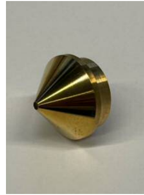
Abbildung 4: Foto des Skimmers, der bisher als Übergangselement zwischen Quelle und Bender genutzt wurde.
