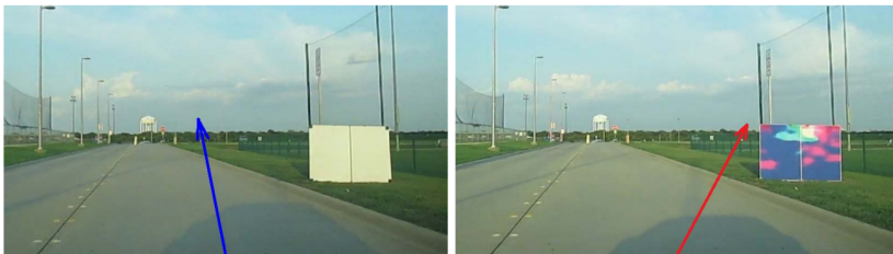
Abbildung 4.4: Das künstliche Hinzufügen einer Werbetafel am Straßenrand (rechts) resultiert in einem modifizierten Lenkwinkel im Vergleich zur Fahrbahn ohne Werbetafel (links). [105]
