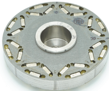
Abbildung 6-24: Blechpaket mit darin vergossenen Magneten
