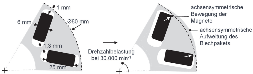
Abbildung 3-14: Unter Fliehkraft massensymmetrisch angenommene Verlagerung der Magnete eines PM-Rotors (in Anlehnung an (Epskamp 2020, S. 91))
