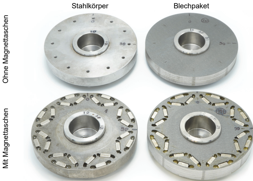
Abbildung 6-4: Für experimentelle Validierung ausgelegte und hergestellte Prüfkörper
