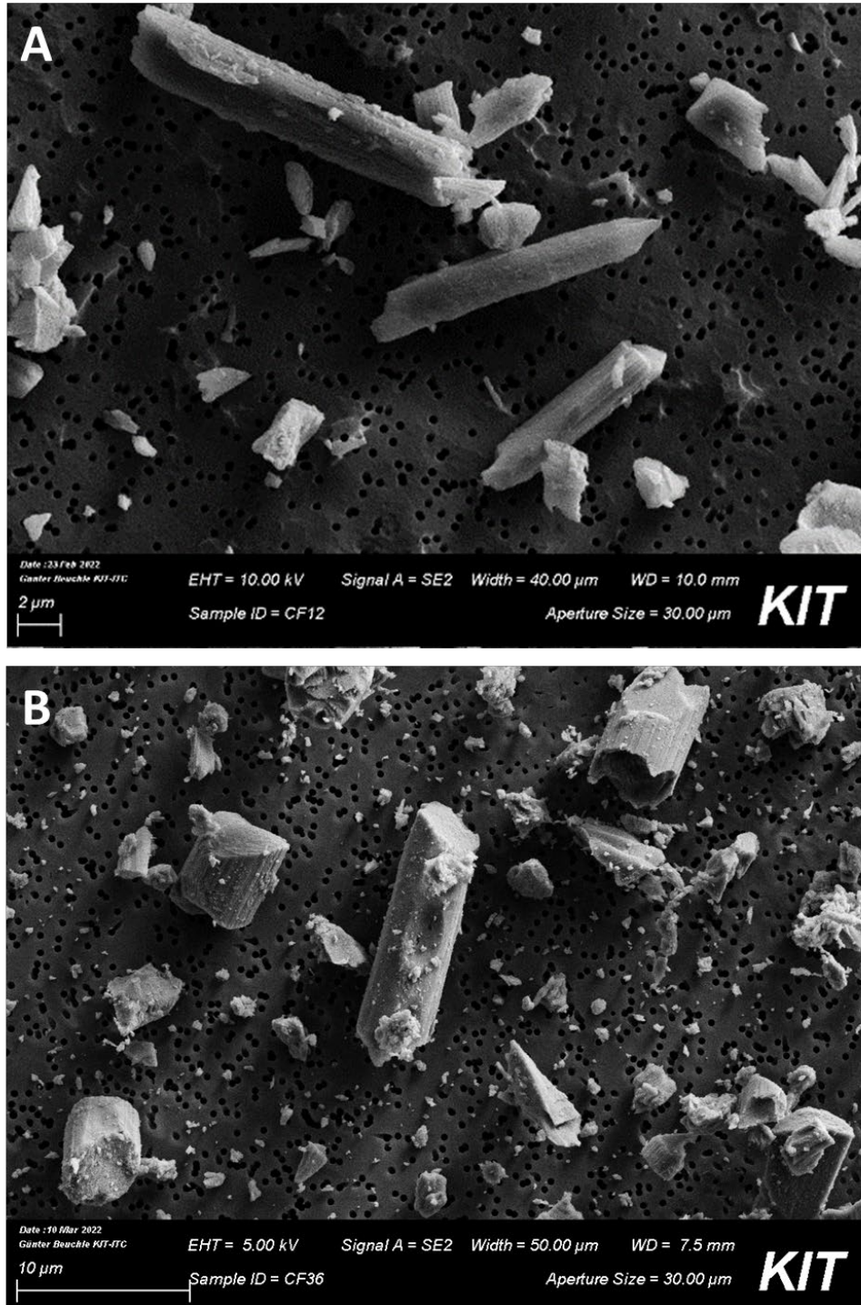
Abbildung 37. Rasterelektronenmikroskopische Aufnahmen von Carbonfaserproben für die Dispergierung als Aerosol. A: mechanisch behandelte Carbonfasern; B: mechanisch-thermisch behandelte Carbonfasern.
