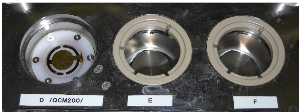
Abbildung 65. Blick in ein Expositionsmodul mit einem QCM-Sensorkopf mit 5-MHz-Kristall. Durchmesser des Sensorkopfs d_{\text{QCM}} = 4 \text{ cm}
