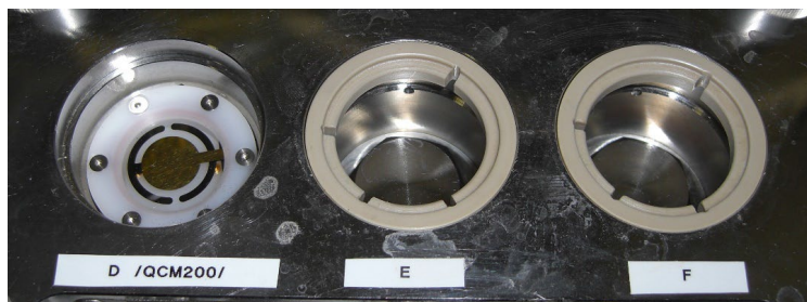
Abbildung 65. Blick in ein Expositionsmodul mit einem QCM-Sensorkopf mit 5-MHz-Kristall. Durchmesser des Sensorkopfs d_{QCM} = 4 \text{ cm}
