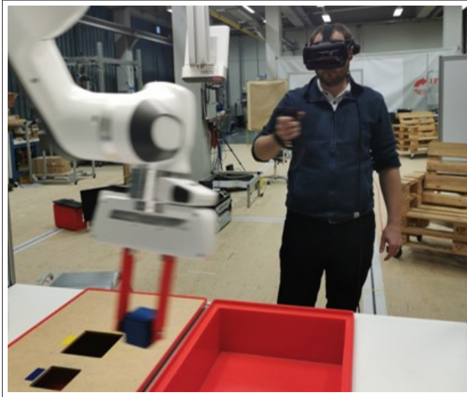
Abbildung 5.7: Teleoperation der Stufe 3/4 mit Visualisierung in VR am entwickelten Demonstrator, eigene Darstellung
