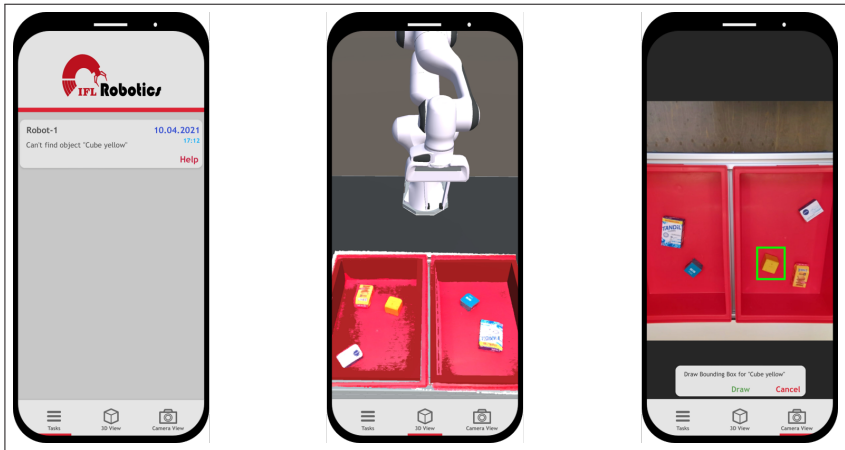
Abbildung 5.6: Darstellung von Teleoperationsstufe 1 und 2 am Beispiel der entwickelten Android-App. Der Teleoperator kann zwischen einer Aufgabenansicht (links), einer 3D-Darstellung (Mitte) und einer 2D-Darstellung wählen, in der über den Touchscreen des Smartphones eine Hilfestellung gegeben werden kann (rechts), eigene Darstellung
