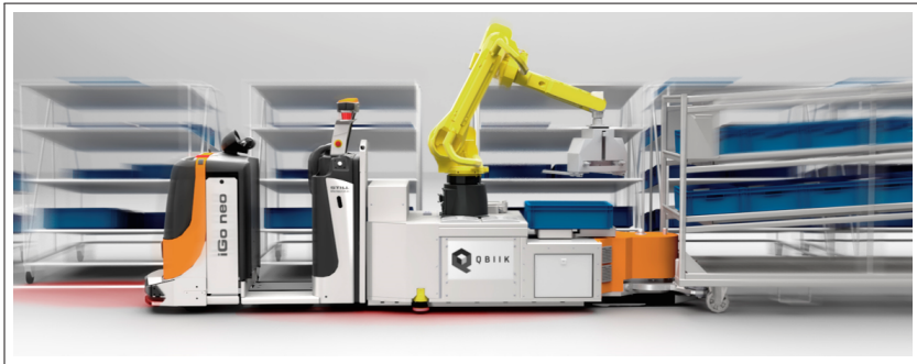
Abbildung 1.2: Forschungsprojekt QBIIK, im Rahmen des PAiCE Technologieprogramms des Bundesministerium für Wirtschaft und Energie (BMWi). Autonome Logistikplattform mit intuitiver Mensch-Maschine-Schnittstelle, eigene Darstellung
