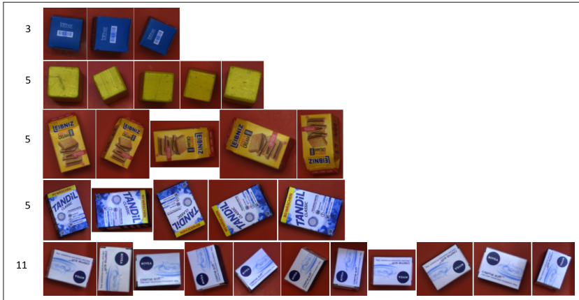
Abbildung 7.21: Durch Teleoperation hinzugefügte Referenzbilder während der ersten 150 Kommissionierungen auf Grund von Erkennungsfehlern der Objekterkennung, eigene Darstellung
