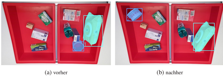
Abbildung 6.6: Kommissionierte Objekte werden in beiden Bildern erkannt und segmentiert (links: vorher, rechts: nachher) [7]
