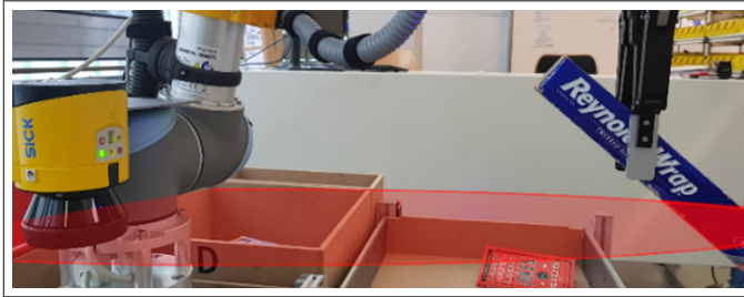
Abbildung 3.13: Laserscanner überwacht den Greifprozess des IFL PiRo Roboters [Colling et al.(2017)Colling, Dziedzitz, Hopfgarten, und Markert et al.]
