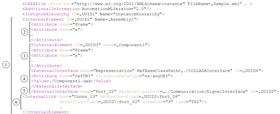
Abbildung 4.5: Exemplarische Darstellung der AutomationML-Struktur einer Baugruppe
