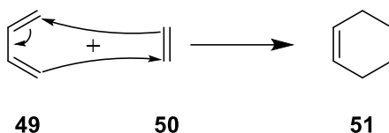
Schema 7: [4+2]-Cycloaddition von 1,3-Butadien ( 49 ) mit Ethen ( 50 ) zu Cyclohexen ( 51 ) als Beispiel der Diels-Alder-Reaktion
