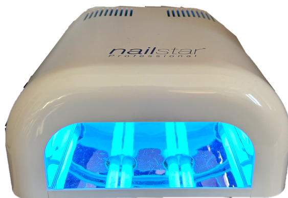
Abbildung 32: UV-Härtegerät (Nailstar) zur Bestrahlung des Objektträgers zur Reaktionsführung. Anregung: 365 nm.
