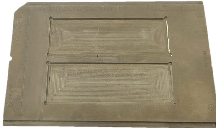
Abbildung 23: Für den Nachweis der miniaturisierten Synthese angepasstes MALDI-Target der Firma Shiamdzu.
