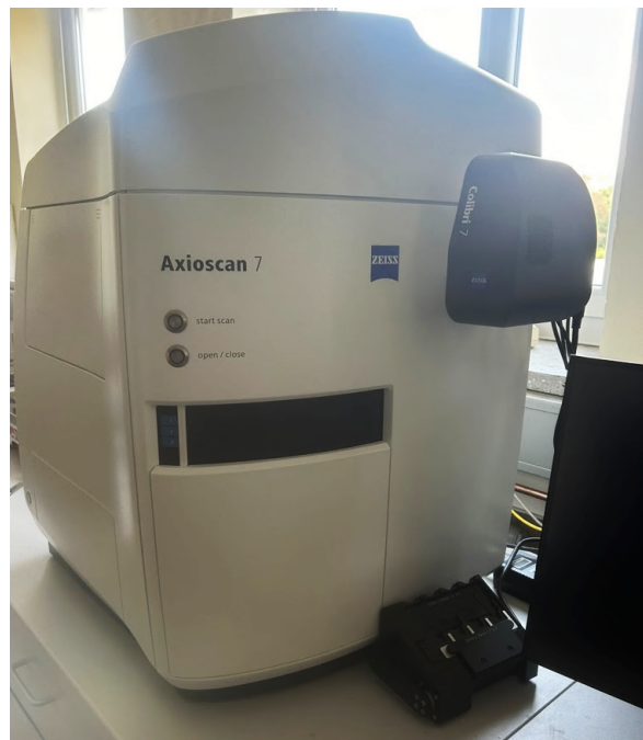
Abbildung 22: Der AxioScan7 in seiner Laboreinrichtung am IMT. Das Fluoreszenzmikroskop ermöglicht die automatisierte hochauflösende Analyse von Objektträgern.
