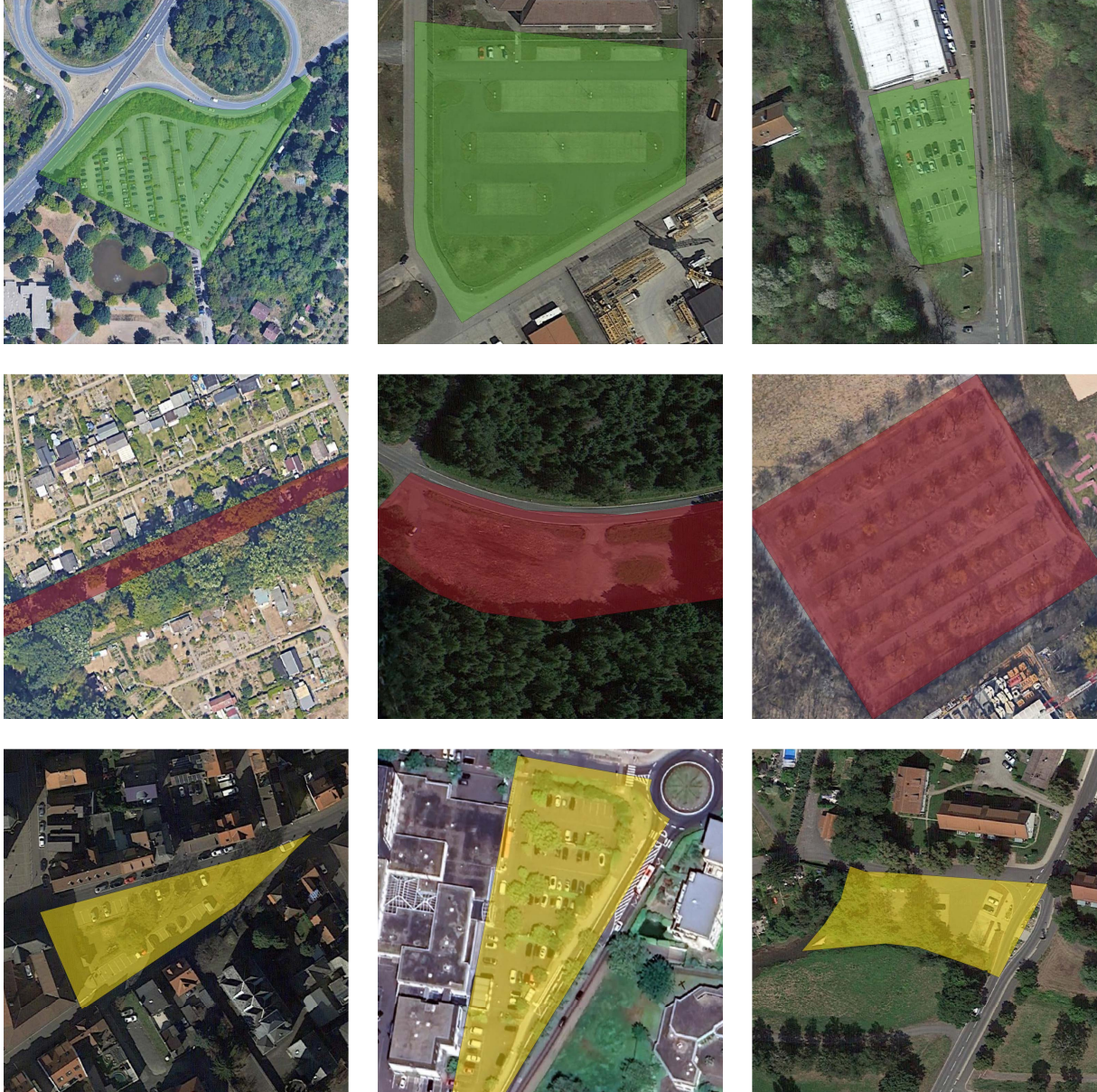
Abbildung 22.6.: Exemplarische Visualisierung von Parkplätzen für PV und die Klassifizierung in die drei beschriebenen Klassen. Die erste Reihe zeigt Beispiele der Klasse „geeignet“, die zweite Reihe der Klasse „ungeeignet“ und die dritte Reihe der Klasse „bedingt geeignet“. Die entsprechend eingefärbten Polygone symbolisieren die Parkplatzflächen.
