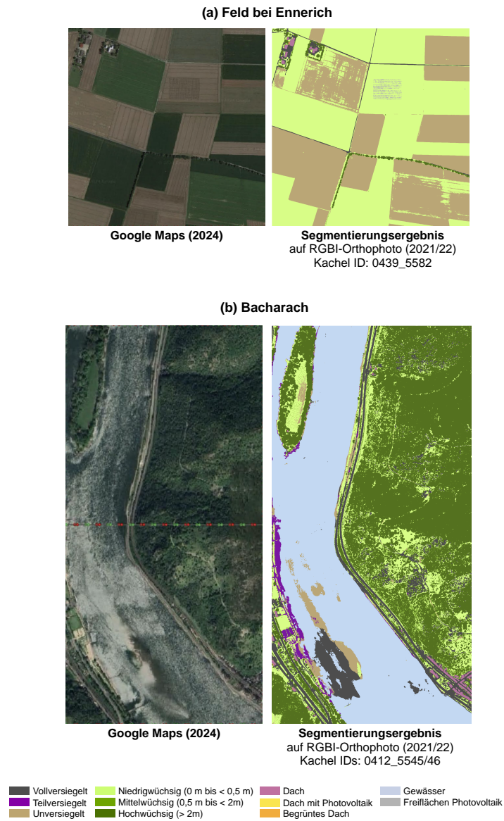
Abbildung 7.5.: Anwendung des Segmentierungsmodells auf drei 1 km × 1 km Beispielkacheln. Oben: Ländlicher Bereich bei Ennerich. Unten: Flussbereich bei Bacharach.
