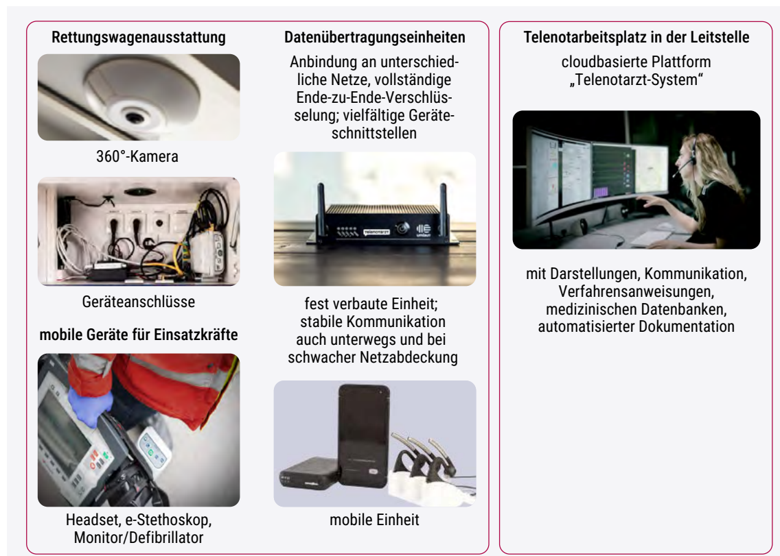
Abbildung 5.5 Technische Komponenten des Aachener Telenotarztkonzepts
