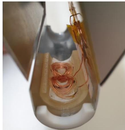
Abbildung 4.12: Auf der Oberseite des 3D-gedruckten Spulenträgers kann die Figure-8-Spule eingesetzt werden. Die Rundung an der Unterseite entspricht genau der Form des Probenkopfes, was eine stabile und reproduzierbare Lagerung der Spule ermöglicht.
