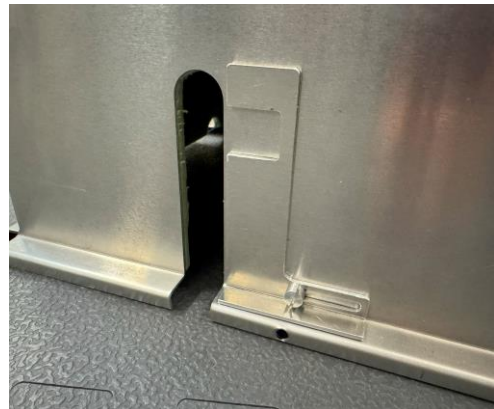
Abbildung 4.13: a) Auf der Bodenplatte der Einhausung sind der Vorverstärker, die Temperiereinheit und der Sensor mit einer 3D-gedruckten Halterung montiert. b) Der Deckel der Einhausung dient zum Schutz vor mechanischen, thermischen und elektromagnetischen Einflüssen aus der Umgebung. c) Die Schlitz im Deckel für die Rohr- und Kabel-durchführungen werden durch verschiebbare Blenden verschlossen.
