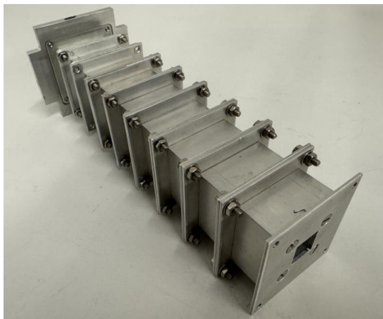
Abbildung 6.4: Die für die Durchflussversuche verwendete Vorpolarisationsstrecke mit einer Länge von 27 cm, die dankenswerterweise von E. Hardy zur Verfügung gestellt wurde. Hierdurch wird bei Durchflussversuchen eine Reduktion der T_1 -abhängigen Wiederholzeit ermöglicht, sodass in der gleichen Messdauer ein besseres Signal-zu-Rausch Verhältnis erreicht wird als ohne Vorpolarisation.
