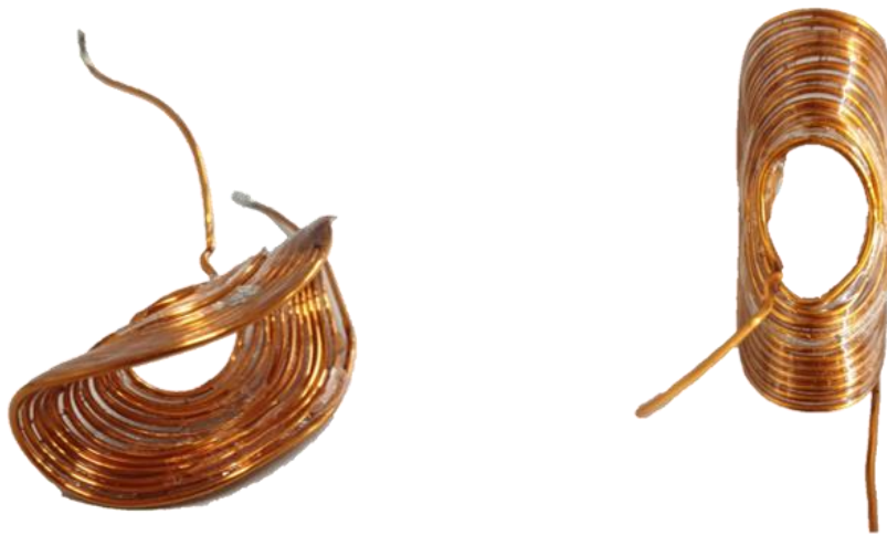
Abbildung 4.6: Die spiralförmig gewundene und gebogene Oberflächenspule wurde aus Kupferdraht mit elf Windungen gewickelt und an ein Rohr mit einem Durchmesser von 10 mm angepasst. Die Länge der Spule beträgt 39 mm. Links: Vorderseite der Spule mit der Rundung, in die das Rohr eingelegt wird. Rechts: Rückseite der Spule.
