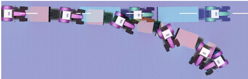
Abbildung 63: Gewünschte Trajektorie (blau) und Unfalltrajektorie (rot) eines Anhängerzuges im Bremsfall
