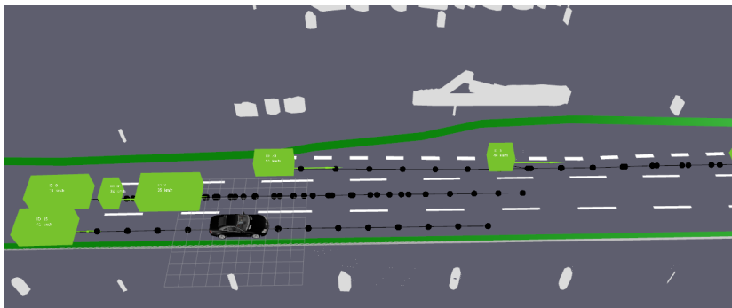
Abbildung 6.5: Visualisierung einer Fahrt im echten Straßenverkehr auf dem Versuchsfahrzeug des Instituts. Die für die hellgrün abgebildeten Fahrzeuge prädizierten Trajektorien sind in Schwarz dargestellt. In Weiß sind jeweils sowohl die der Planungskarte entnommenen Fahrbahnmarkierungen sowie statische Objekte, welche von den Sensoren außerhalb der Fahrstreifen der Fahrzeuge erkannt wurden, abgebildet. Die Grenze des befahrbaren Bereiches ist in Dunkelgrün hervorgehoben.
