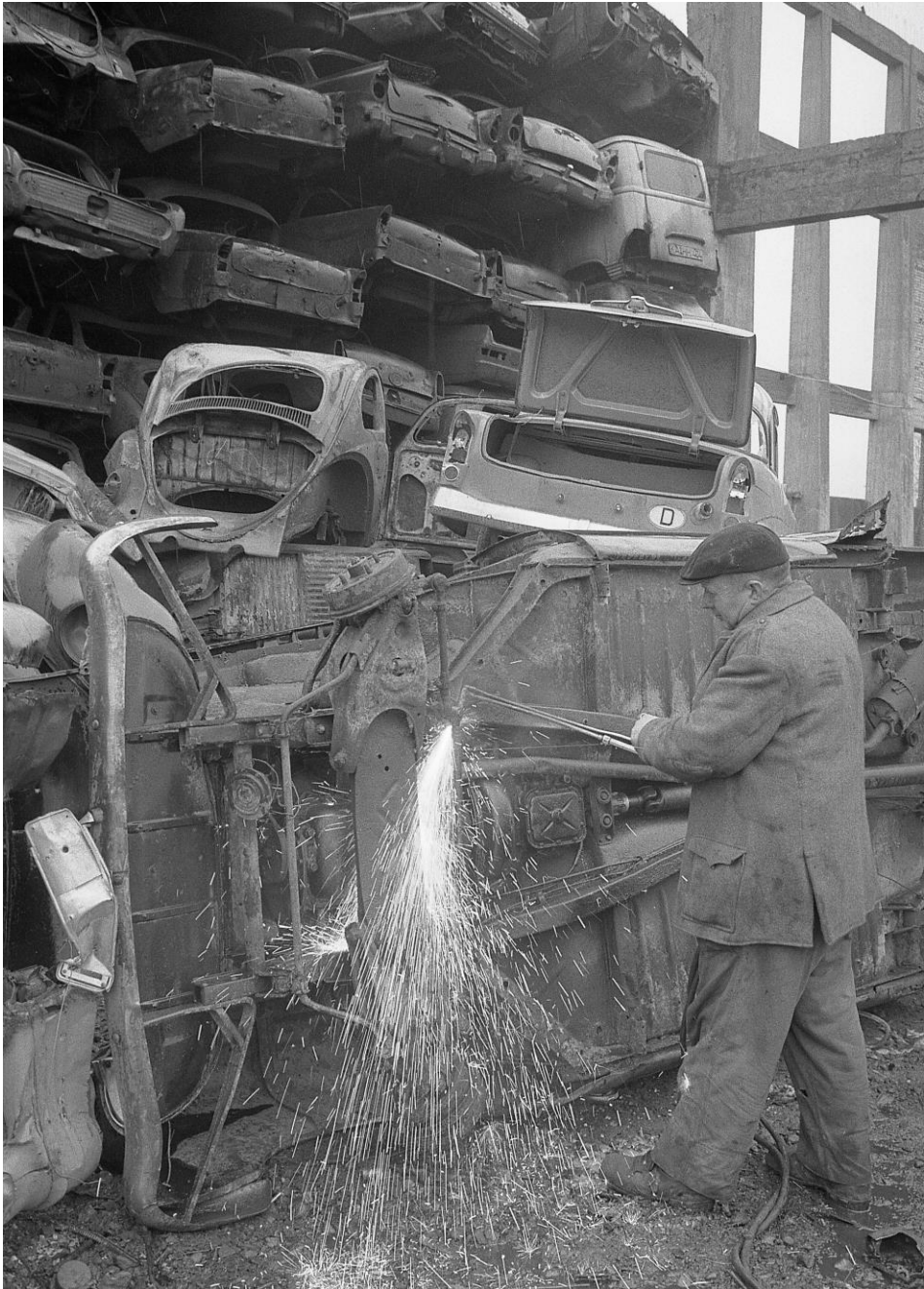
Abbildung 12: Manuelles Herausschweißen verwertbarer Teile aus einem Schrottauto, Karlsruhe 1968. Stadtarchiv Karlsruhe, 8/BA Schlesiger 1968 / A 15 124/5/37.
