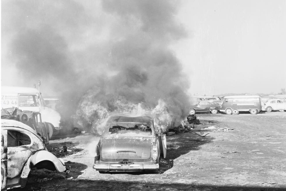
Abbildung 10: Ausbrennen eines Pkws zur „Entsorgung“ nichtmetallischer Bestandteile auf einem Schrottplatz in Oststeinbek, Schleswig-Holstein, 1968. Kreisarchiv Stormarn, I 1 / 35822.
