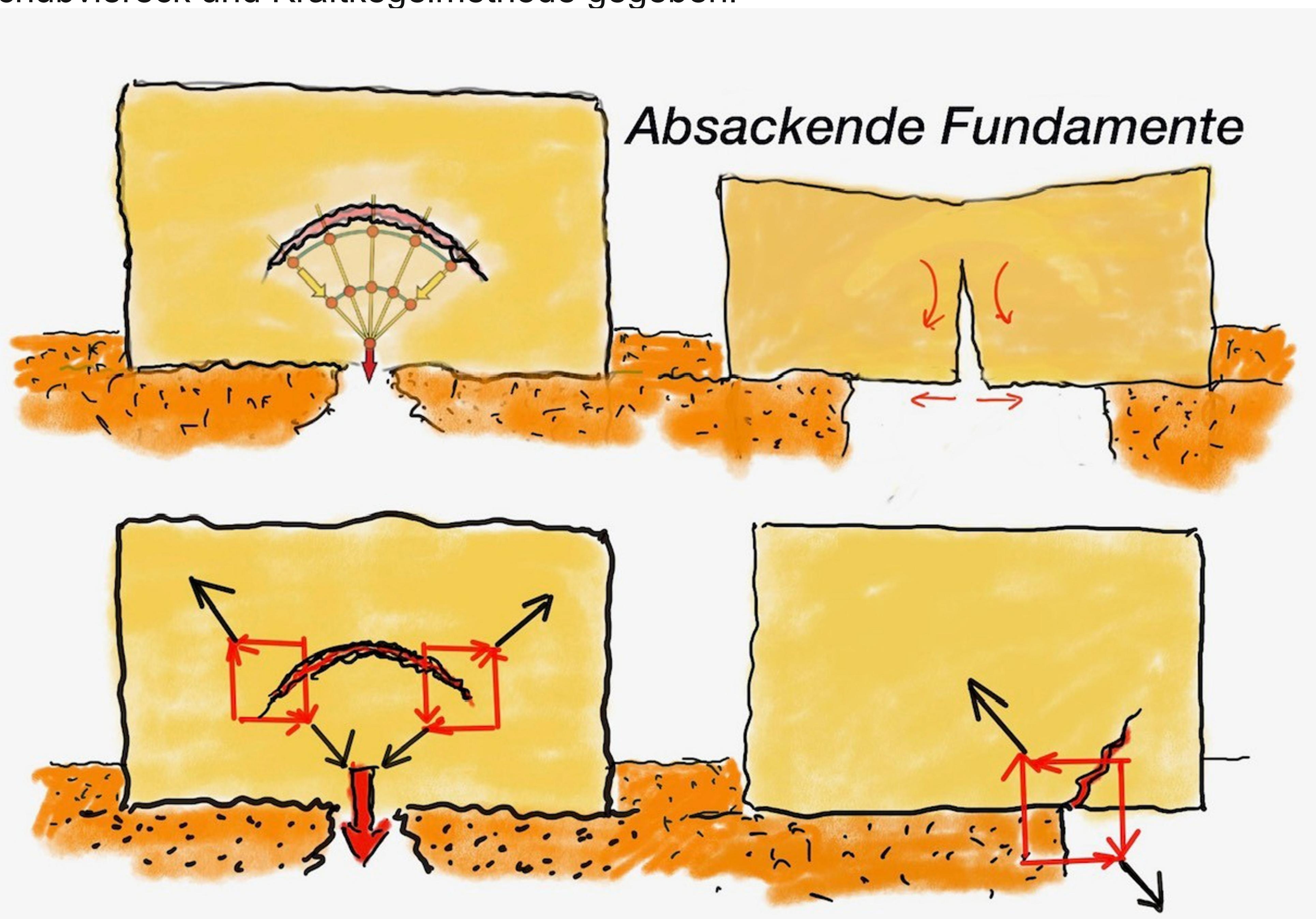
**Fazit:** Zur Vertikalen um 45° geneigte Risse resultieren oft aus Zug, der aus dem Schubviereck abgeleitet wird. Senkrechte Risse sind in der Regel Risse infolge Biegezuges. Beide Risstypen können gleichzeitig auftreten.
