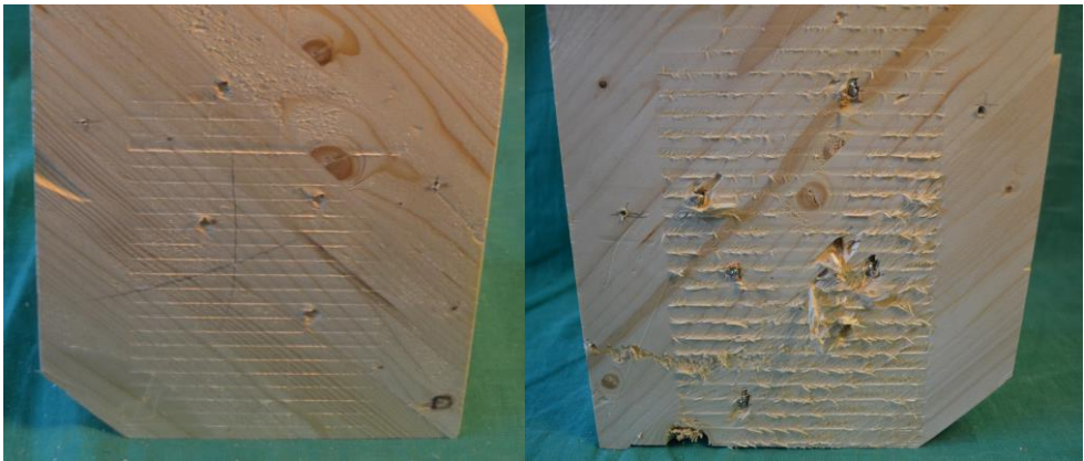
Abbildung 52: BSH nach Belastung mit Abdruck der Kerven: Serie 4 (links) – Serie 9 (rechts)
