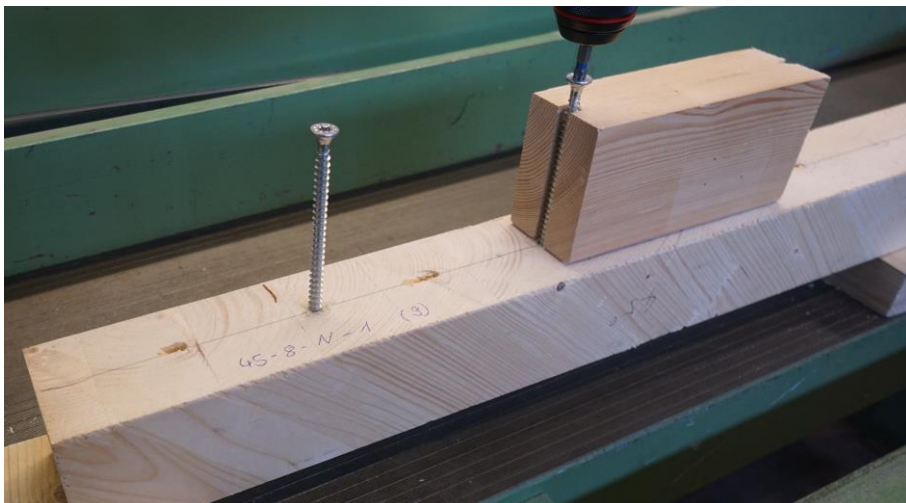
Abbildung 30: Geführte Montage der Schrauben
