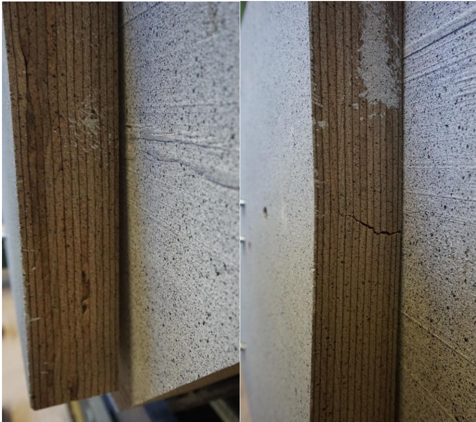
Abbildung 76: Spalt in Scherfuge (links) und Riss aufgrund von Biegezug quer zur Faser (rechts)
