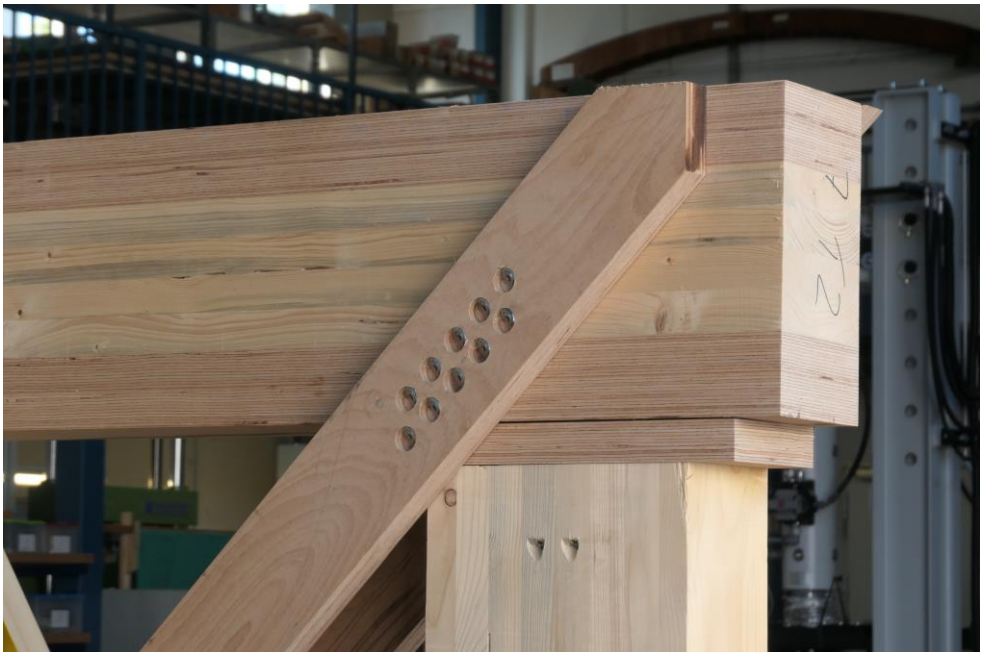
Abbildung 4: Knotenpunkt mit geneigt eingebrachten Schrauben
