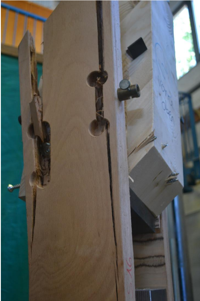
Abbildung 51: Aufspalten einer Zuglasche aus LVL ohne Querlagen (Serie 6)
