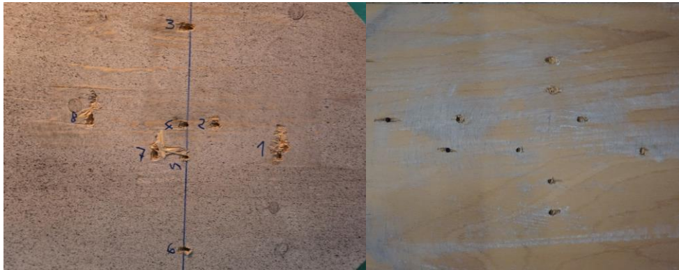
Abbildung 72: Deutlicher Abrieb der Farbe am Mittelholz (links) und Anhaftungen am Seitenholz (rechts)
