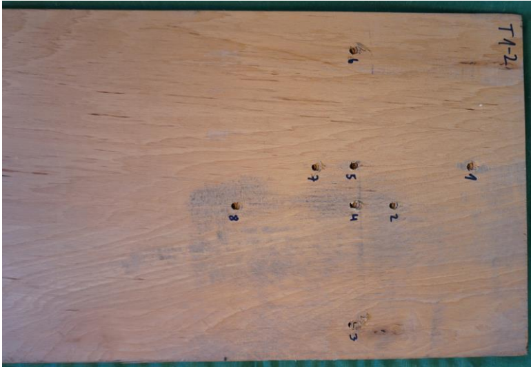
Abbildung 90: Farbanhaftung an Seitenholz
