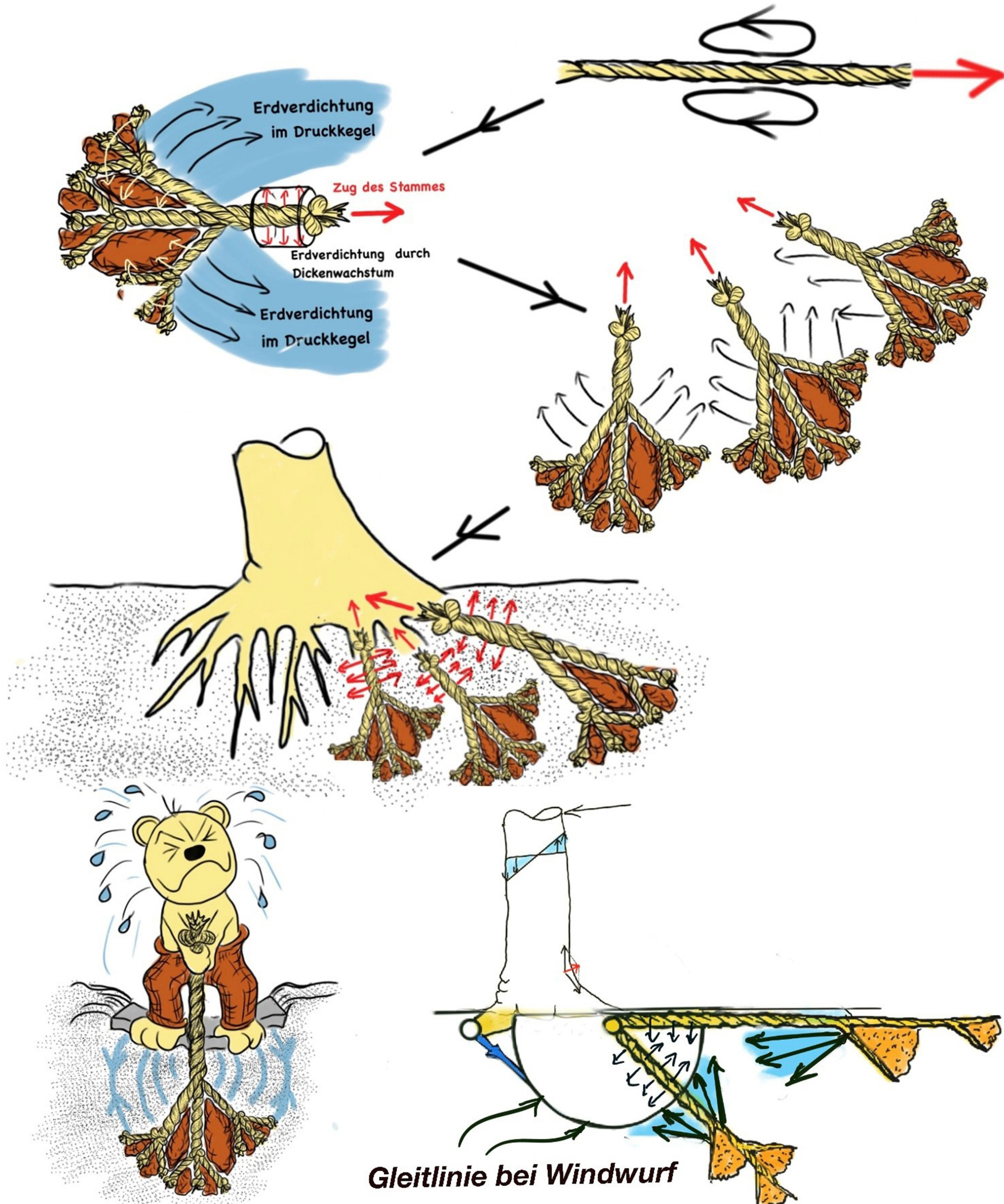
**Fazit:** Die Erde der Wurzelplatte wird einerseits durch Dickenwachstum der Wurzeln und andererseits durch moderate Windlast auf die Wurzelendknoten verdichtet und damit verfestigt. Dies gilt insbesondere für die potenzielle Gleitlinie bei Wurf.
