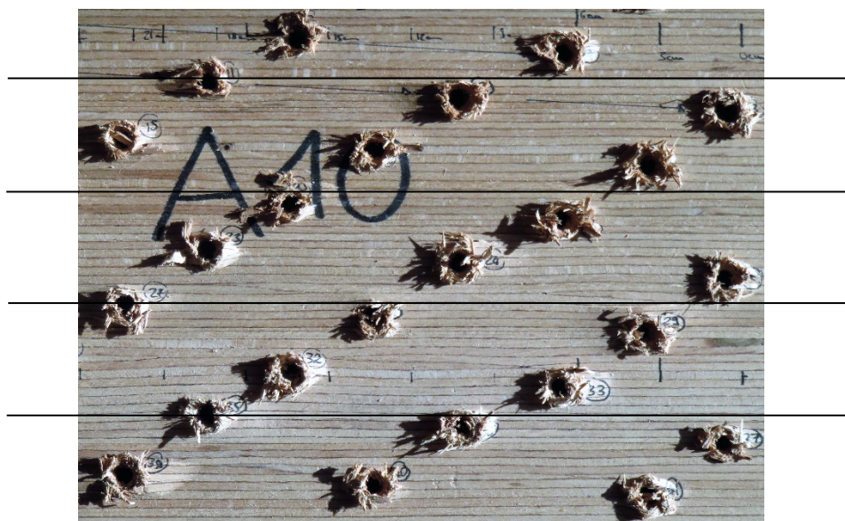
Bild 8 Systematisches Variieren der Position von Einschraubstellen in der Schmalfläche von Brettschichtholz aus Buchenfurnierschichtholz; schwarze Linien kennzeichnen die Lage der Sekundärklebefugen
