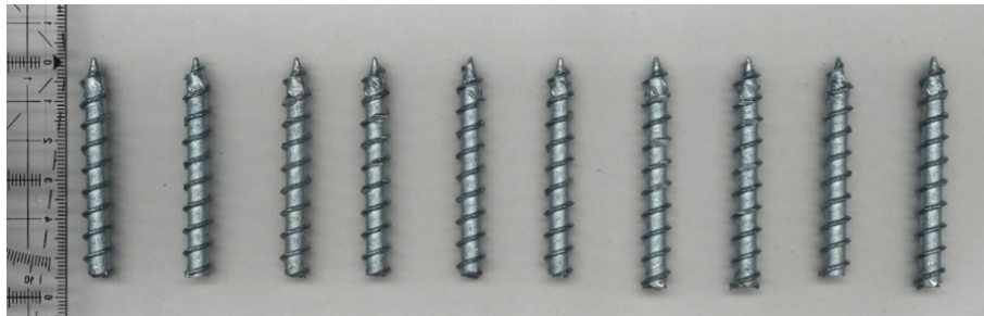
Bild 21 Abgedrehte Gewindeteile bzw. Schraubenspitzen
