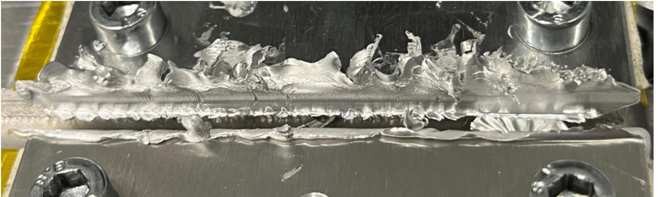
Abbildung 6–16: Trennschnitt bei instabilen Prozessparametern mit überhöhten Temperaturen (A_Zöller 2023)
