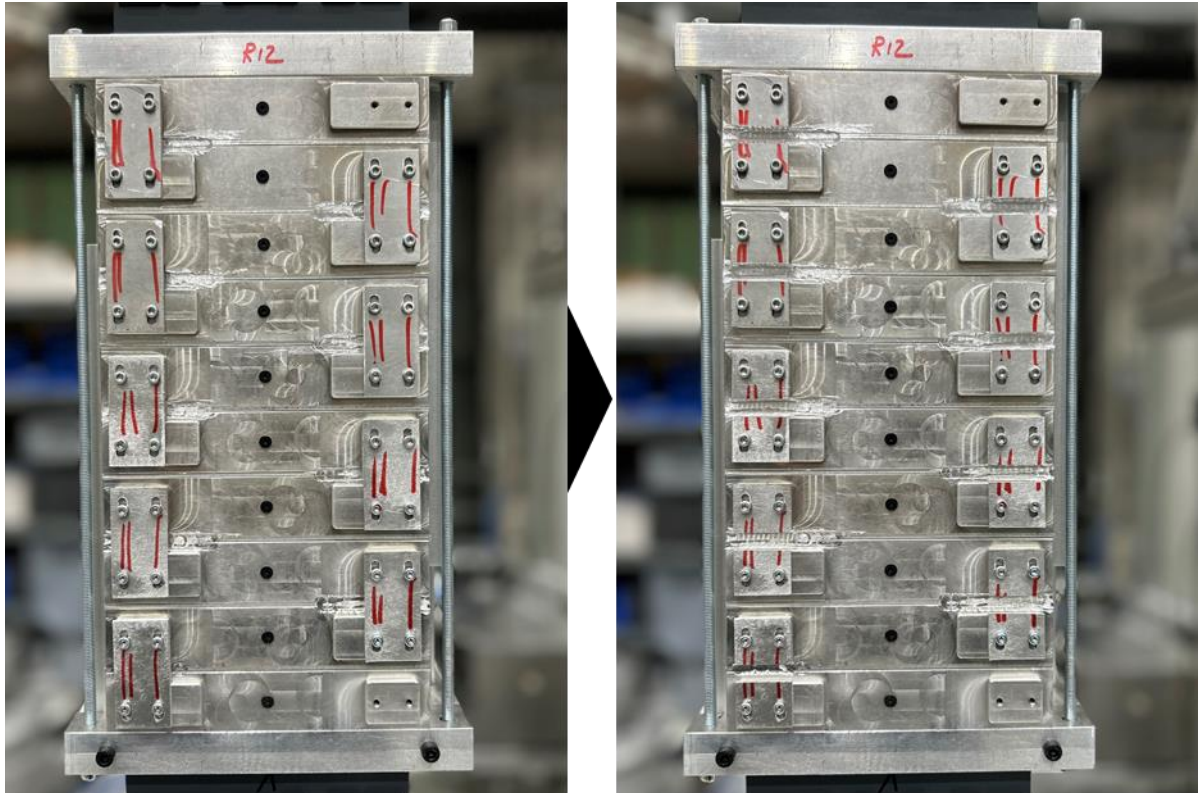
Abbildung 8–10: Erfolgreiche Trennschnitte beim Dummy-Batteriemodul mit zehn Zellen (vorher und nachher)
