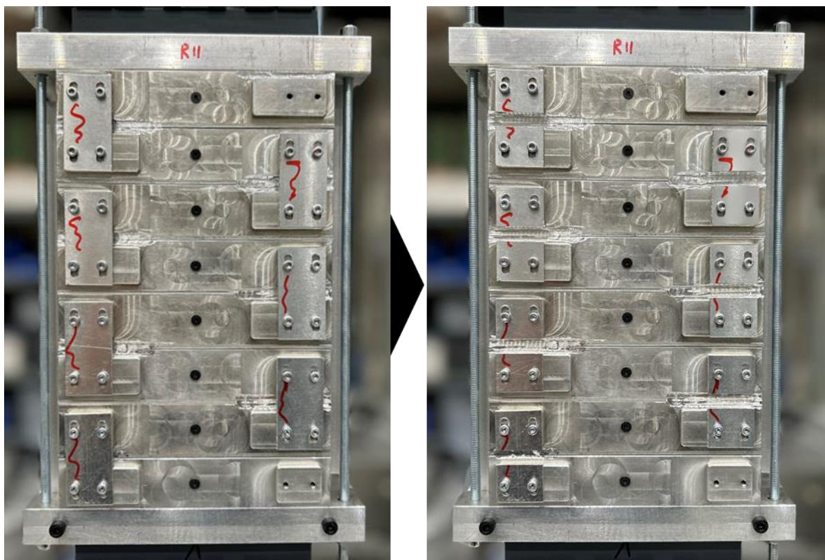
Abbildung 8–9: Erfolgreiche Trennschnitte beim Dummy-Batteriemodul mit acht Zellen (vorher und nachher)
