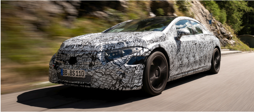
Abbildung 3.5: Erprobungsträger mit der typischen Tarnung des Fahrzeugdesigns durch aufgeklebte Folien, Kunststoffverschalung, abgeklebte Scheinwerfer sowie dem Fehlen aller Markenzeichen (Bild: [Mer20a])
