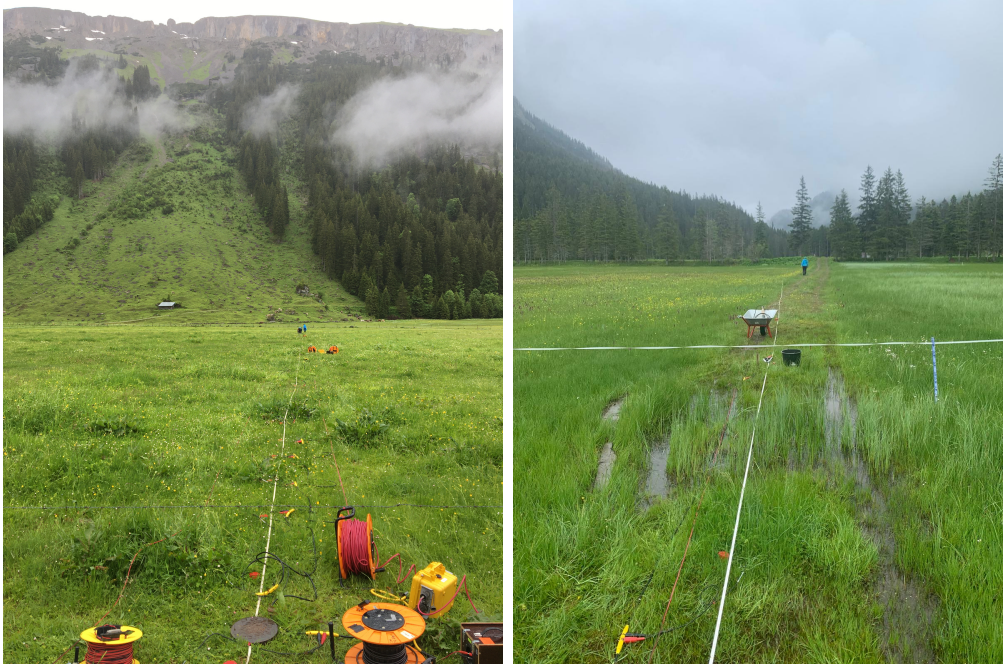
Abbildung 12: Messauslagen auf Profil 3 (links) und 4 (rechts). Auf Profil 3 sind die Geophone entlang eines Maßbands in regelmäßigen Abständen gesteckt. Unten im Bild sind die Kabelrollen, Schlagplatte, sowie eine Geode (gelber Kasten) zusehen.
