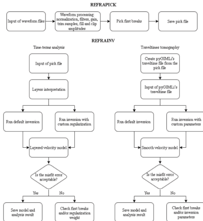
Abbildung 13: Der Workflow der Programme RefraPick und RefraInv. Die Auswertung erfolgte nach diesem Schema. Zunächst werden die Daten im Programm RefraPick eingelesen, prozessiert und schließlich die Erstankunftszeiten ausgelesen. Mit diesen startet der Inversionsprozess in RefraInv.
