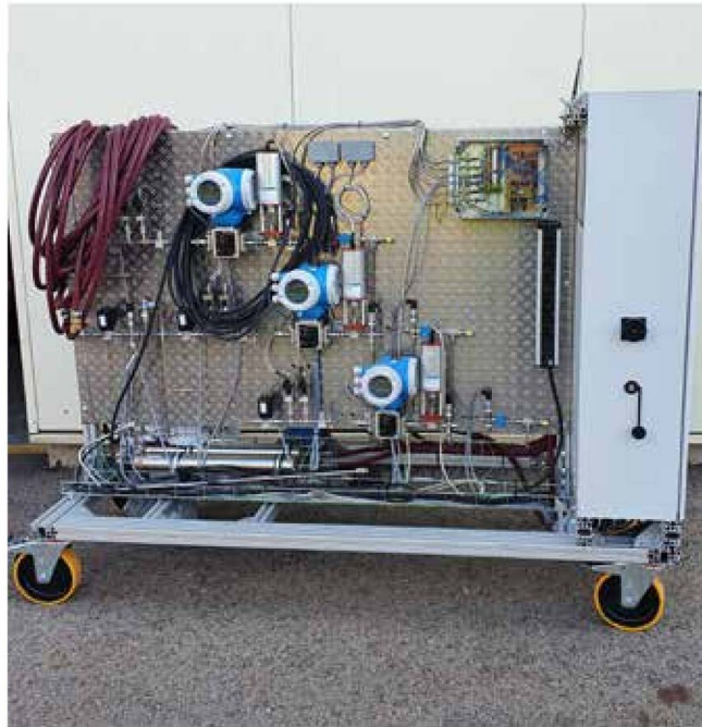
Abb. 3: Tube-Blocking-Anlage für Feldversuche.
