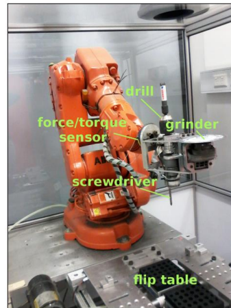
Abbildung 2-4: Demontagezelle der University of New South Wales (Foo et al., 2021a)
