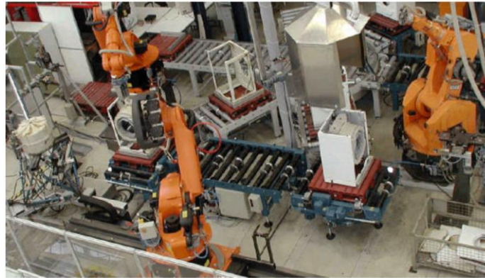
Abbildung 2-3: Pilot-Demontagezelle der Demontagefabrik (Stenzel, 2001, S. 90)
