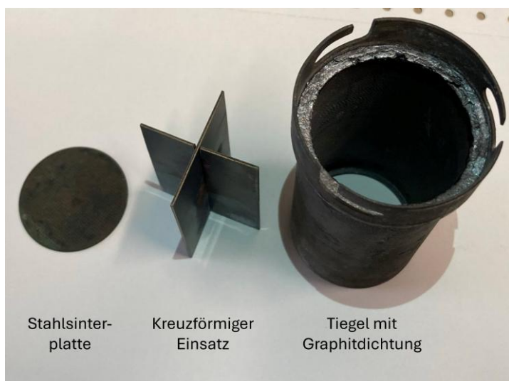
Abbildung 42. Für die Kohlenstoffreinigung verwendeter Stahltiegel mit Sinterplatte und kreuzförmigem Einsatz.
