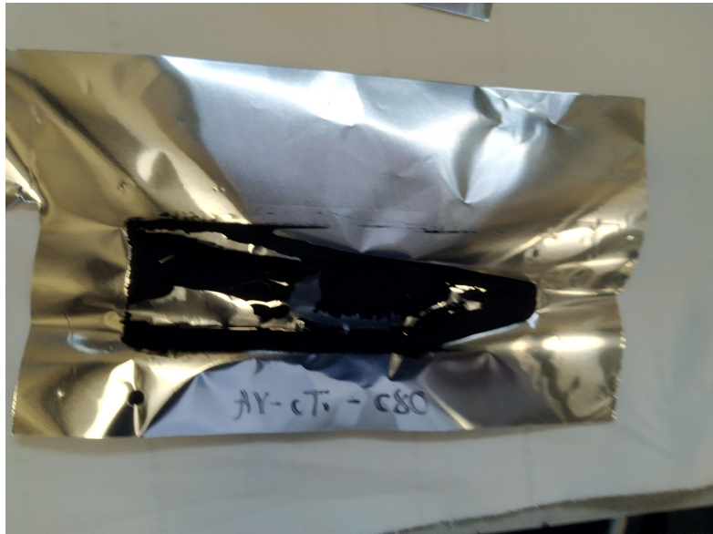
Abbildung 11.11: Foto einer Elektrode, die Haftungsprobleme hat.
