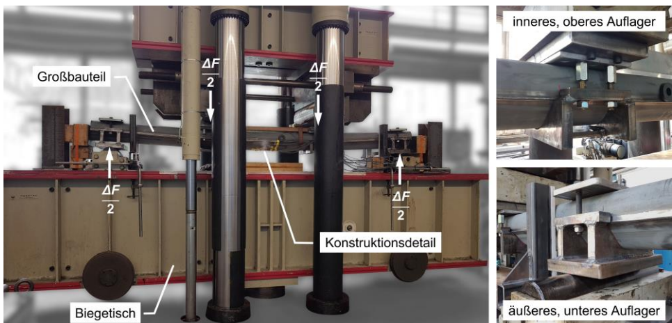
Abbildung 3.25: Versuchsstand mit Großbauteil im 4-Punkt-Biegeschwingversuch (links) sowie Nahaufnahmen der Lasteinleitungspunkte (rechts)
