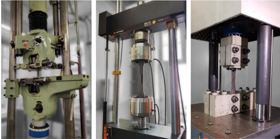
Abbildung 3.17: Ermüdungsversuchsprüfstände für die Kleinprüfkörper – servohydraulische Prüfmaschinen (links und mittig) und Resonanzpulsator (rechts)
