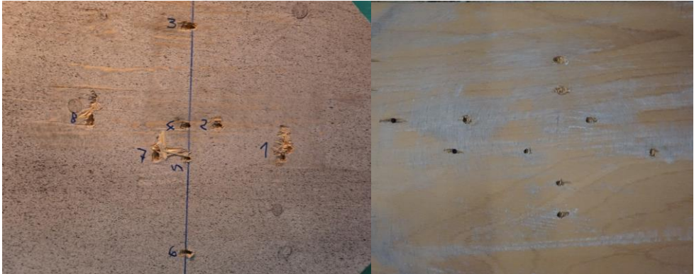
Abbildung 72: Deutlicher Abrieb der Farbe am Mittelholz (links) und Anhaftungen am Seitenholz (rechts)
