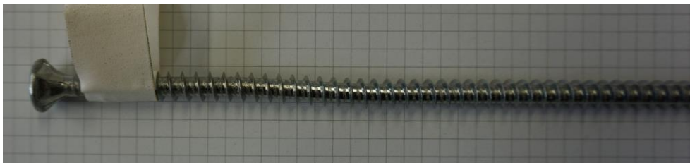
Abbildung 71: Fließgelenkausbildung an einer überwiegend axial beanspruchten Schraube (Schraubenposition 6)
