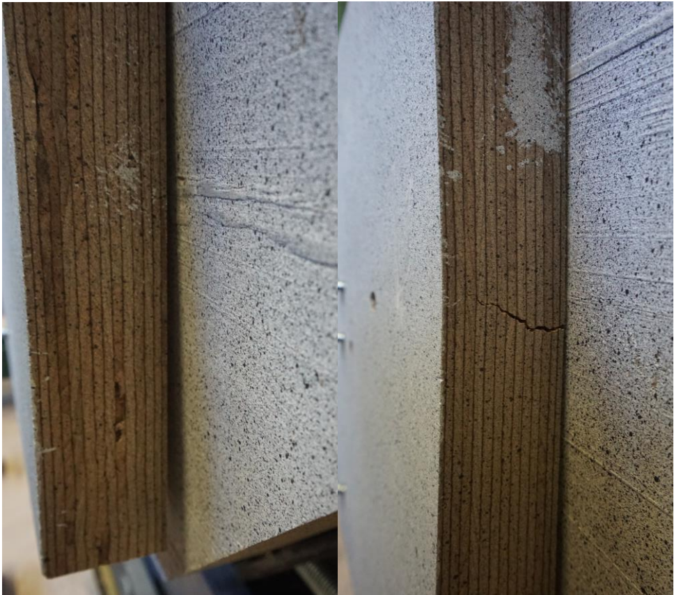
Abbildung 76: Spalt in Scherfuge (links) und Riss aufgrund von Biegezug quer zur Faser (rechts)
