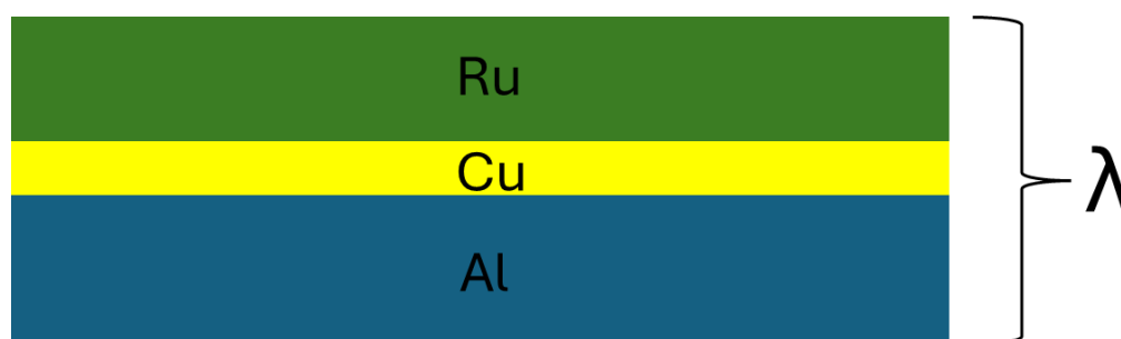
Abbildung 5.75: schematischer Aufbau einer periodischen Wiederholeinheit mit Dreilagendicke \lambda im System Cu/Ru/Al
