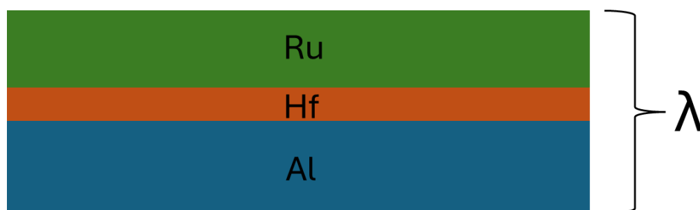
Abbildung 5.35: schematischer Aufbau einer periodischen Wiederholeinheit mit Dreilagendicke \lambda im System Hf/Ru/Al
