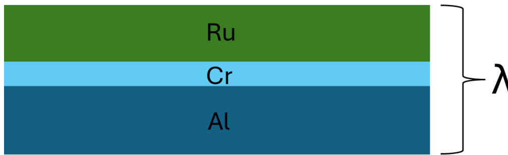
Abbildung 5.58: schematischer Aufbau einer periodischen Wiederholeinheit mit Dreilagendicke \lambda im System Cr/Ru/Al
