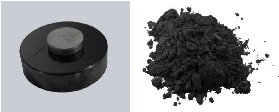
Abbildung 25: Beispiel einer hergestellten Probe Aluminium/Kupfer(II)-oxid (20:80) als Tablette (links) und als Schüttung (rechts).
