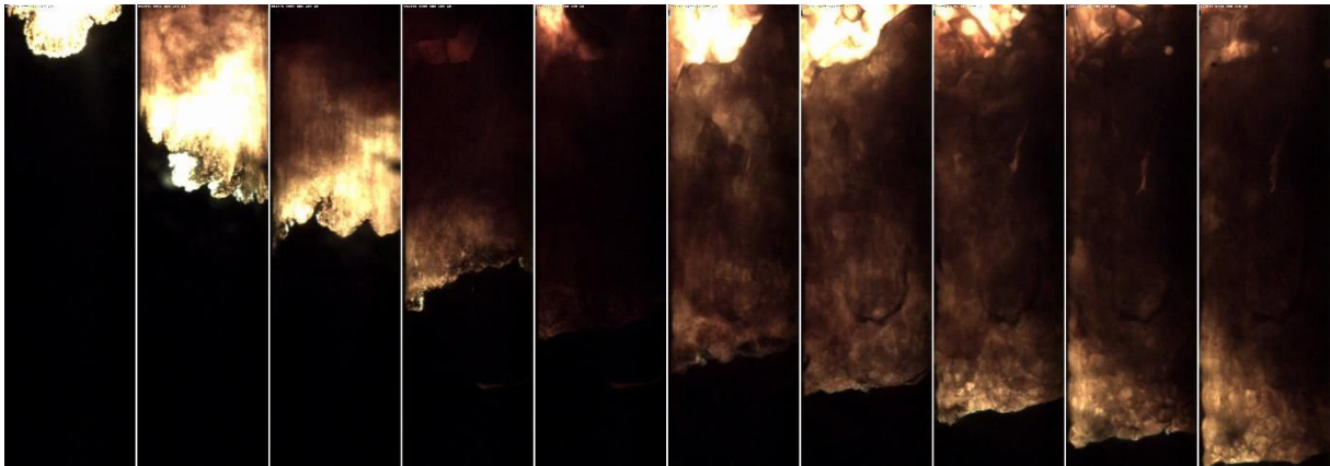
Abbildung 41: Zeitlicher Verlauf des Abbrands der stöchiometrischen Mischung von Al/CuO (19:81).
