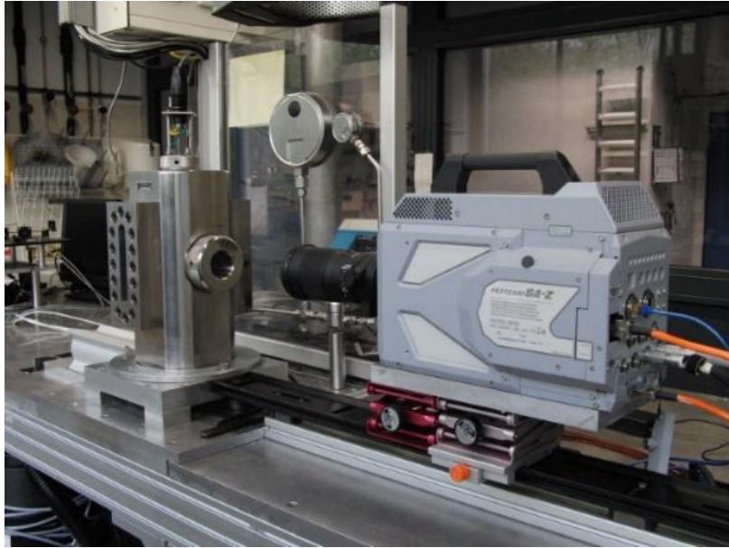
Abbildung 34: Der Versuchsaufbau mit optischer Bombe (links) und Hochgeschwindigkeitskamera (rechts).
