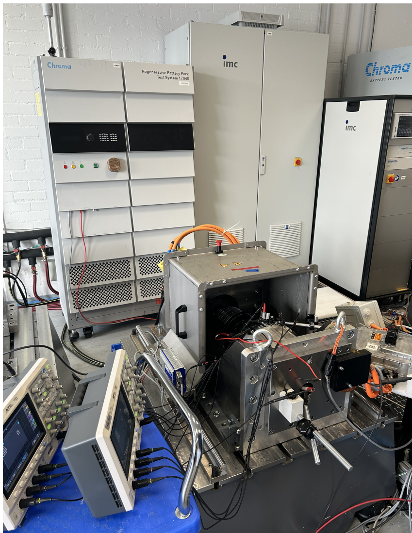
Abbildung 8.1: Foto des verwendeten Motorprüfstands zur experimentellen Validierung des HF-Motormodells sowie zur Verifizierung der Maßnahmen gegen parasitäre Effekte
