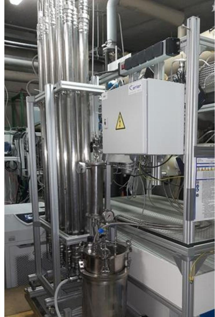
**Isolierte Verweilstrecke zur Darstellung reaktiver Prozesse im System (mineralische Ausfällungen, Entgasung)**
