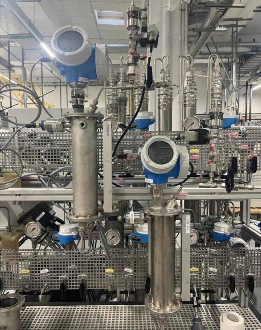
**Gasfallen mit Radarsonde und Sichtglas zur Füllstands-kontrolle sowie magnetischen Auslassventilen zur automatisierten Messung der Gaszusammensetzung**
