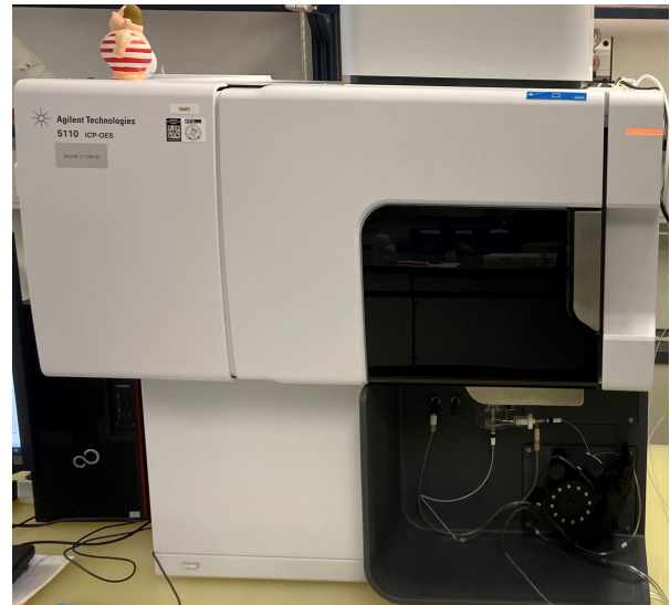
Abbildung 3.21: Verwendetes ICP-OES-Gerät mit angeschlossener Zerstäubungseinheit zur Aerosolbildung (grauer Bereich unten)
