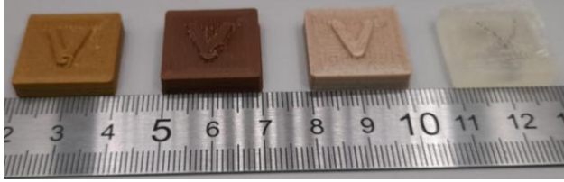
Bild 1 Gedruckte Testkörper aus PLA-Matrix-Kompositen. Von links nach rechts: Pinie, Kork, Holzfasern sowie reines PLA als Referenz. Das sich an der Oberfläche befindliche „V“ gibt die Druckrichtung an
