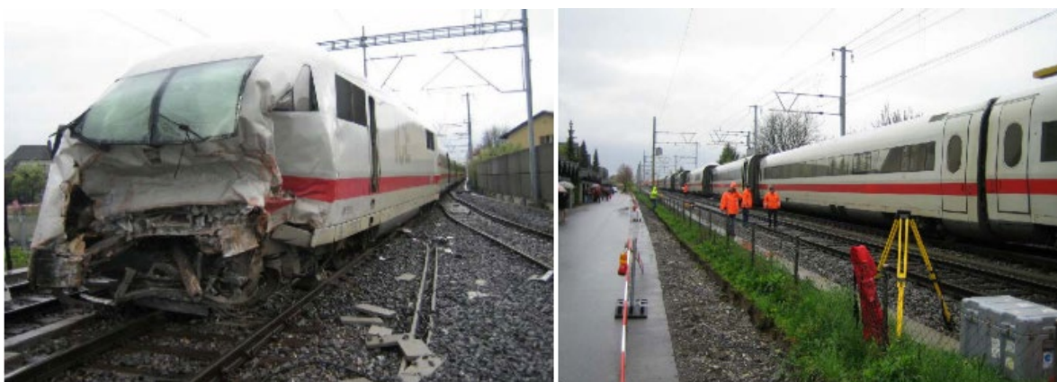
Abbildung 31: ICE-1-Triebkopf und Wagen nach Zusammenstoß [100]
