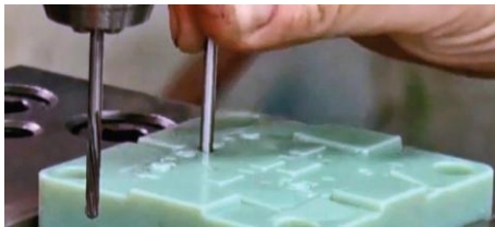
Abbildung 3.12: Überprüfung der gebohrten Passung [10]
