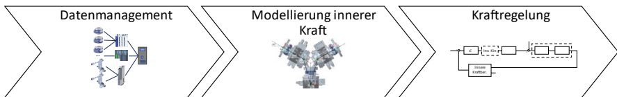
Abbildung 4-4: Schematischer Prozessablauf zur Verspannungskompensation der Roboter
