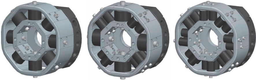
Abbildung 5-14: Konfigurationsmöglichkeiten zur Einstellung der Federsystemsteifigkeit (in Anlehnung an A_Arzberger 2022)
