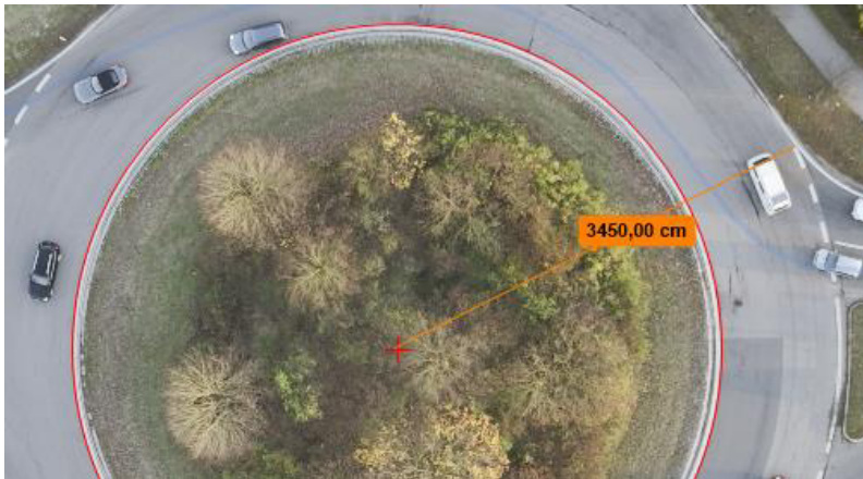
Abbildung 51: Kalibrierung des Videos anhand der Länge und Ausrichtung einer bekannten Strecke
