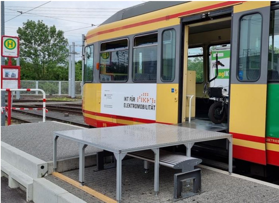
Abbildung 2-35: Bahnsteigaufbau zum Höhenausgleich und Klappe zur Spaltüberbrückung
