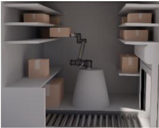
Abbildung 2-47: Roboterarm beim Greifen und Sortieren eines Paketes
