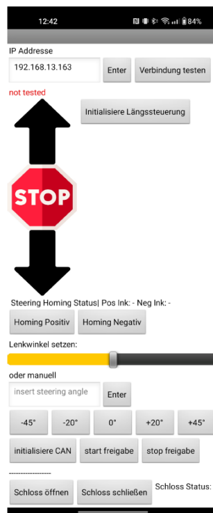
Abbildung 2-38: Grafische Oberfläche der App zur Fernsteuerung des Trailers
