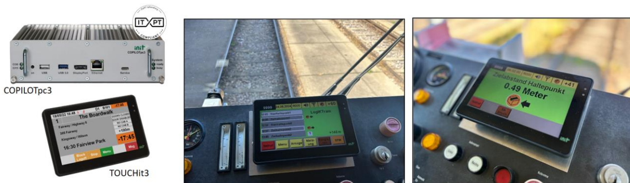
Abbildung 2-19: Integration der Informationen aus der IKT-Plattform sowie dem Ladungsträger und des Tramsystems auf dem Bordrechner COPILOTpc3 und dem Bedienteil (TOUCHit3)
