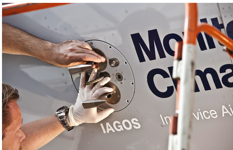
Einbau einer IAGOS-Einlassplatte in ein Flugzeug der Deutschen Lufthansa (Foto: mit freundl. Genehmigung der Deutschen Lufthansa).
