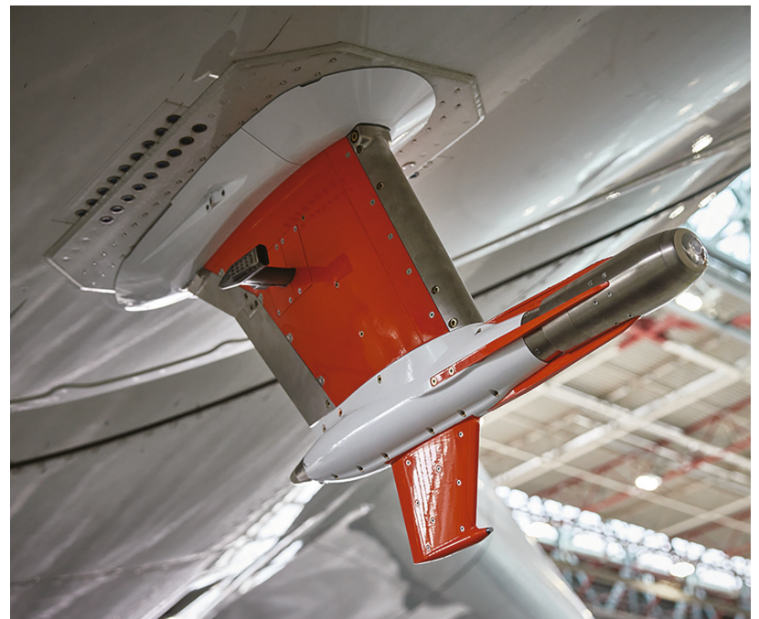
Abb. 6 Experten der Lufthansa Group haben am Flughafen München erstmals die eigens für das Projekt IAGOS-CARIBIC entwickelte Messsonde am unteren Flugzeugrumpf der Lufthansa A350 D-AIXJ angebracht (Foto: Oliver Roesler).
