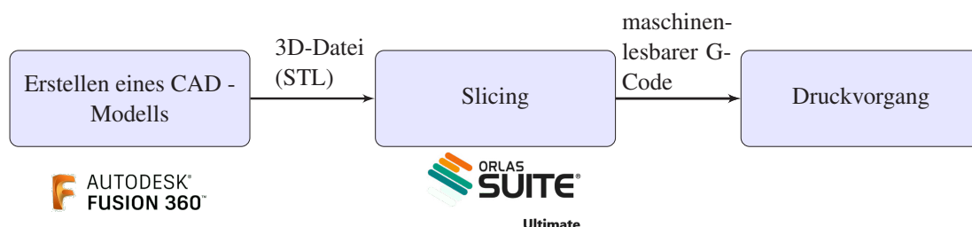
Abbildung 3.1: Additiver Fertigungsablauf, vereinfacht nach [16, 46, 246] und VDI 3405 Blatt 5.1. Das gewünschte Bauteil muss zunächst mittels C omputer A ided D esign konstruiert werden, anschließend im separaten Softwarepaket für den Druckprozess verarbeitet und in den maschinenlesbaren G-Code übersetzt werden.
