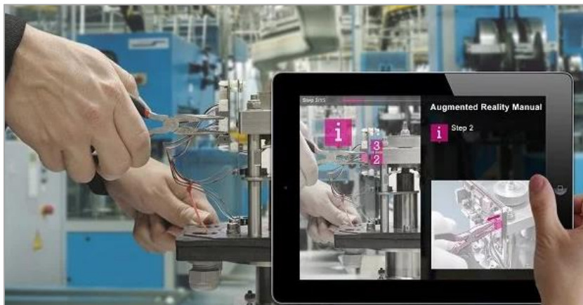
Abbildung 2.2.2-10: Beispiel für eine AR-basierte Montageanleitung (©Fraunhofer IGD - AR-Anwendung mit Tracking-Technologie „VisionLib“)
