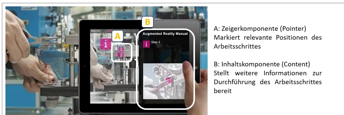
Abbildung 2.2.2-15: Anwendungsbeispiel des AVA-Konzeptes (Ergänzte Darstellung, Bildquelle: ©Fraunhofer IGD - AR-Anwendung mit Tracking-Technologie „VisionLib“)
