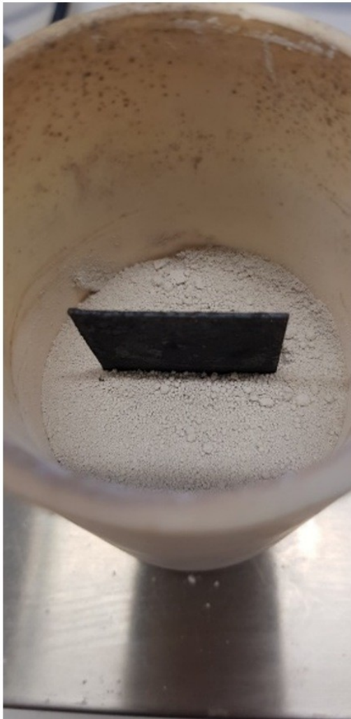
Abbildung 3-1: Korrosionstest an Hastelloy mit/ohne Materialkontakt
