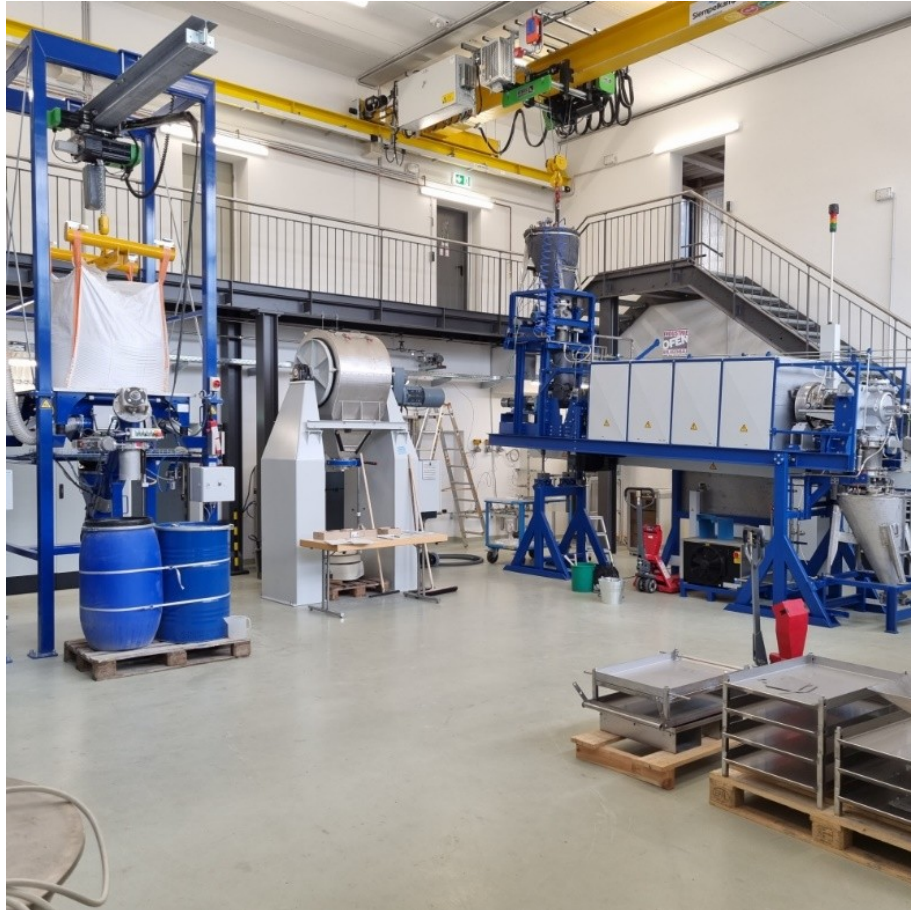
Abbildung 4-2: R-Zement-Pilotanlage mit Bigbagstation, Mühle, Drehrohr
