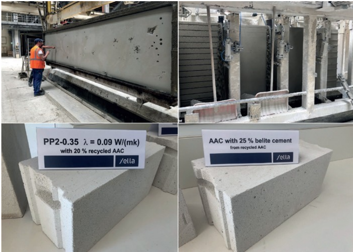
Abbildung 6-1: Herstellung von Porenbetonprototypen im Großtechnikum der Xella Technologie- und Forschungsgesellschaft mbH; unten links: Porenbeton Planblock Ytong® PP2-0,35 mit 20 % Massenanteil an Altporenbeton; unten rechts: Porenbeton Planblock mit RC-Belitzementklinker (Quelle: Xella Technologie- und Forschungsgesellschaft mbH)
