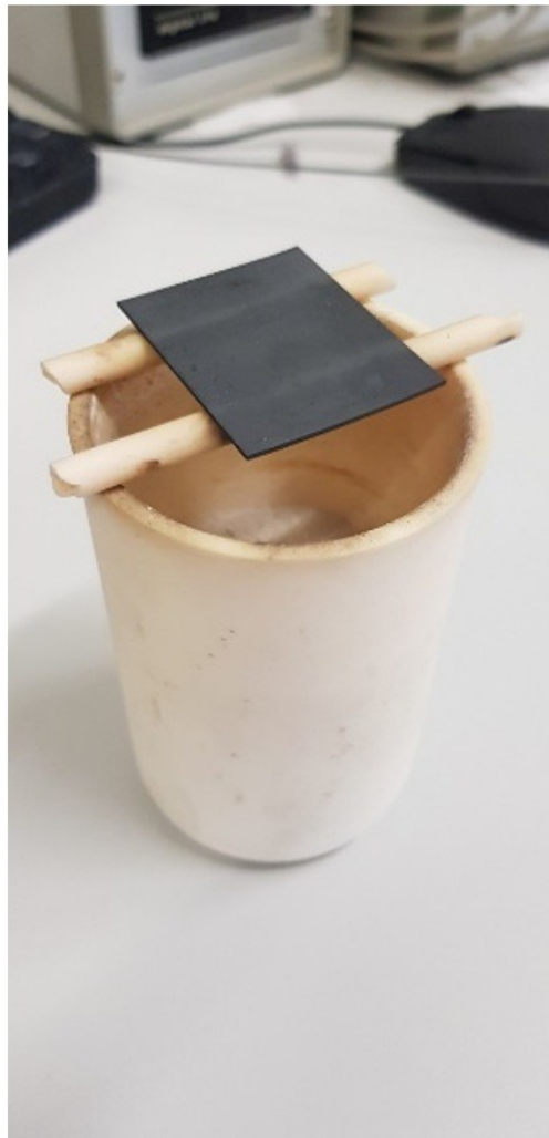
Abbildung 3-1: Korrosionstest an Hastelloy mit/ohne Materialkontakt
