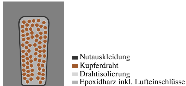
Abbildung 3.17: Beispiel der Statorwicklung in einer Nut
